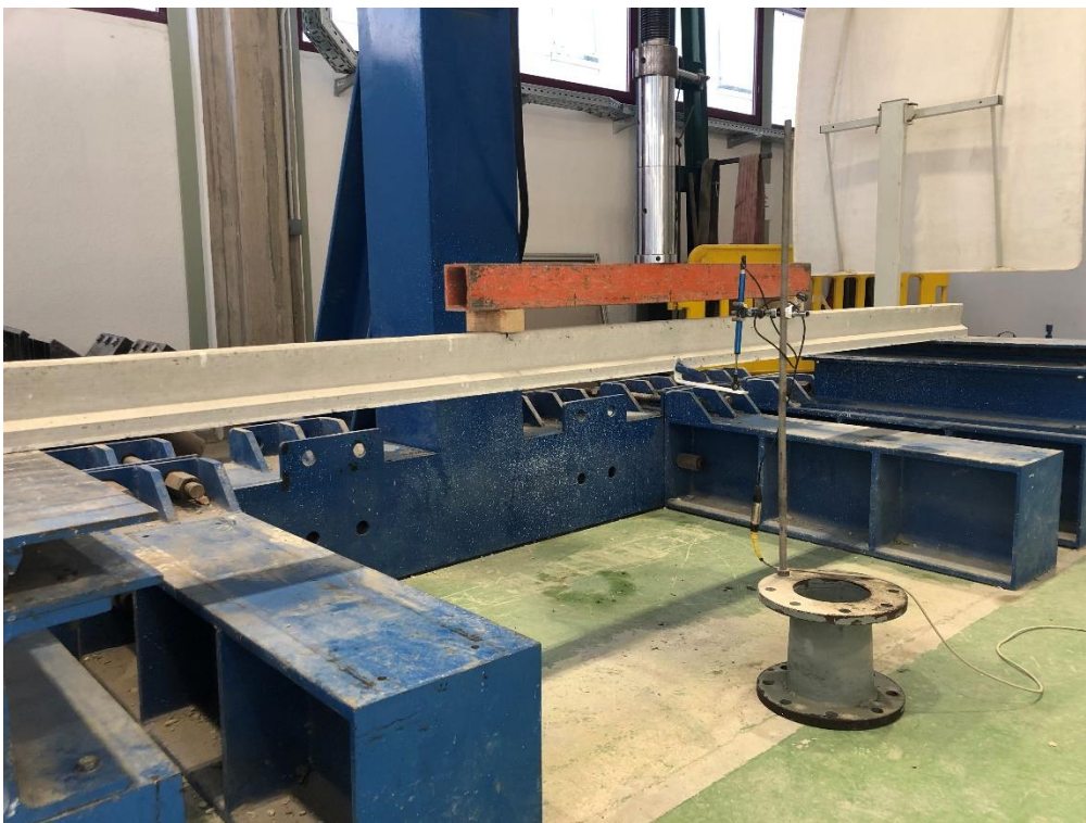
Figura 75. Rotura Vigueta T12.2- laboratorio de hormigón UPV
