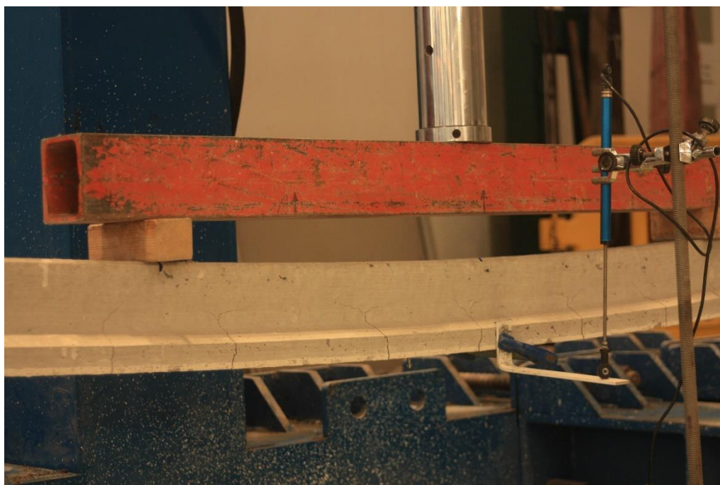
Figura 83. Aumento de flecha y apertura de fisura Vigueta T12.2 (Imagen E)
