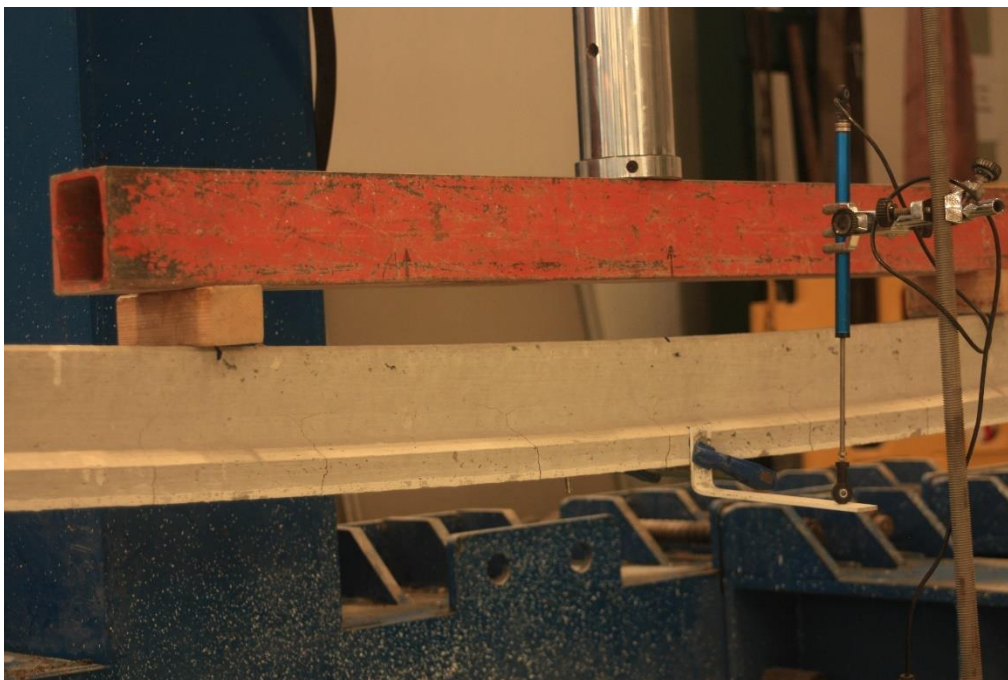
Figura 81. Aumento de flecha y apertura de fisura Vigueta T12.2 (Imagen C)
