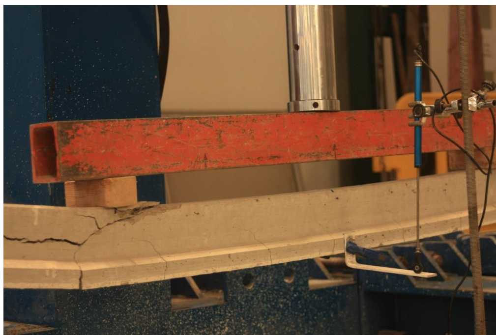
Figura 85. Aumento de flecha y apertura de fisura Vigueta T12.2 (Imagen G)
