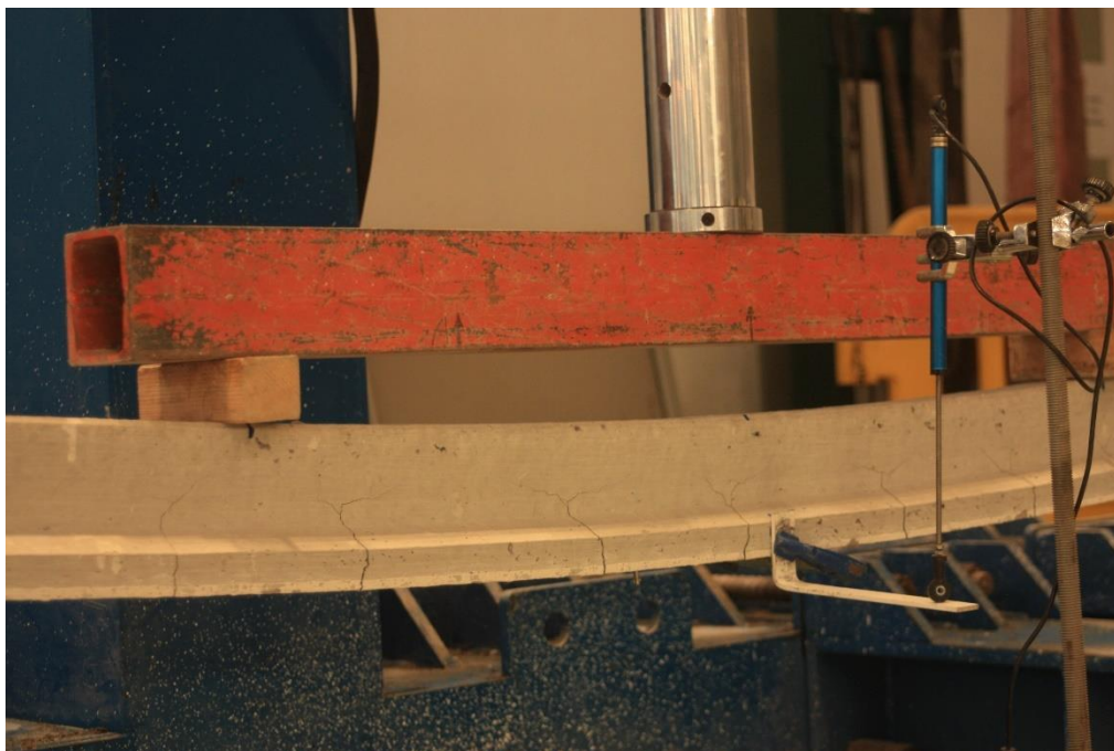
Figura 85. Aumento de flecha y apertura de fisura Vigueta T12.2 (Imagen G)
