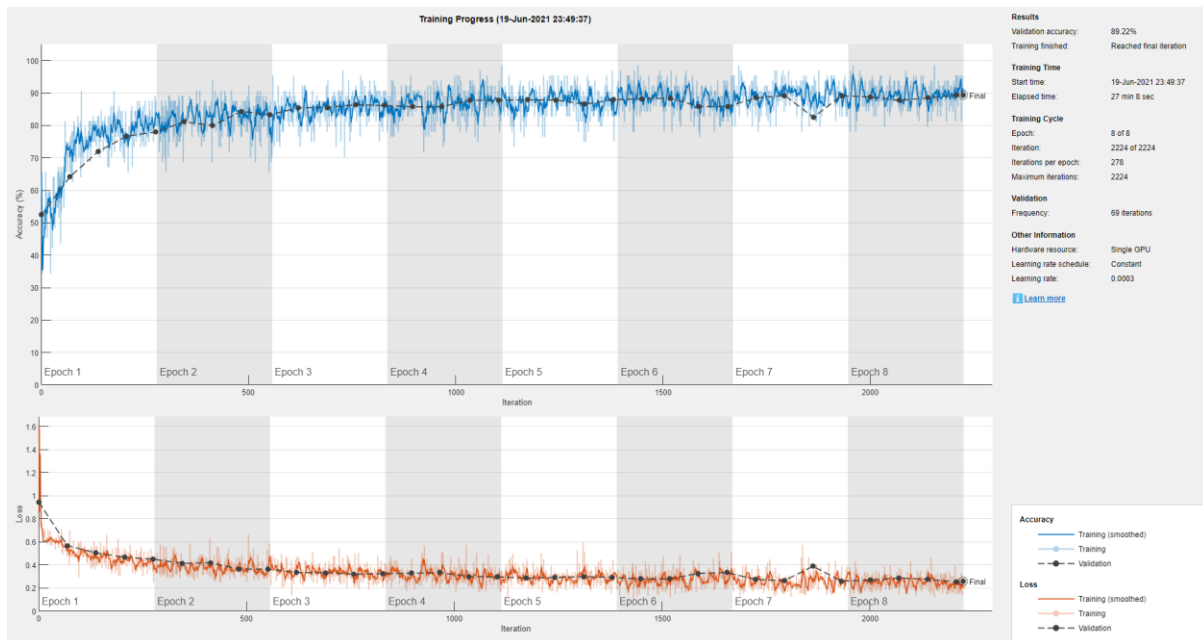
Figura 58. SqueezeNet proceso de entrenamiento precisión de validación 89.22%
