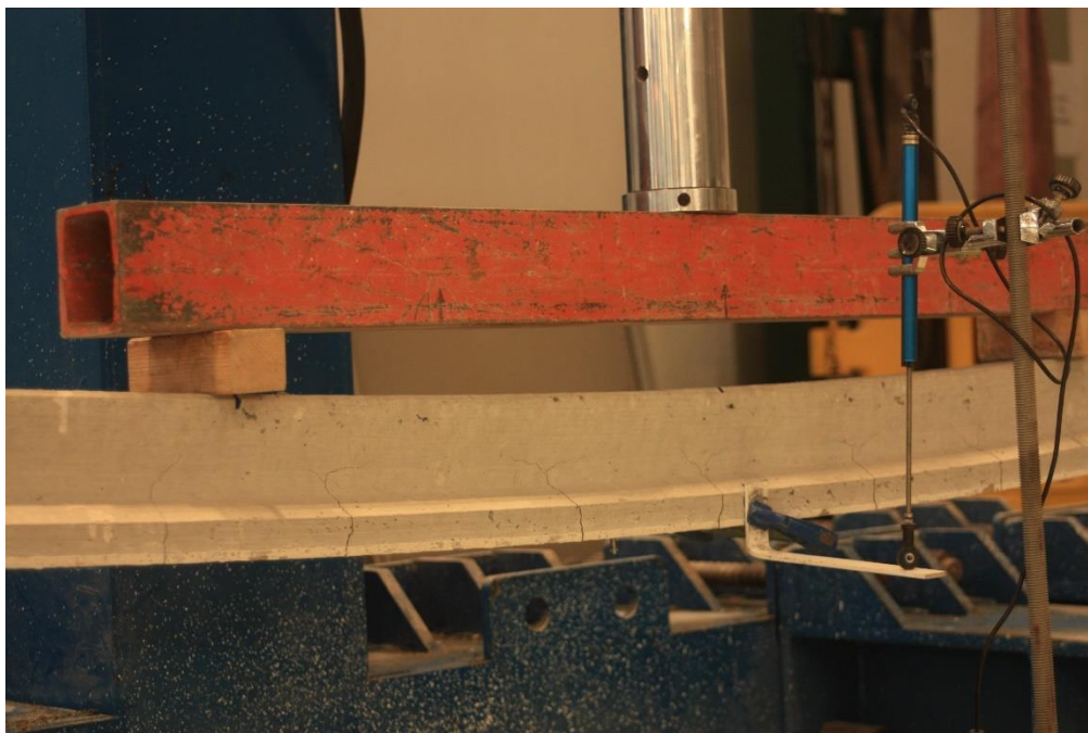
Figura 83. Aumento de flecha y apertura de fisura Vigueta T12.2 (Imagen E)
