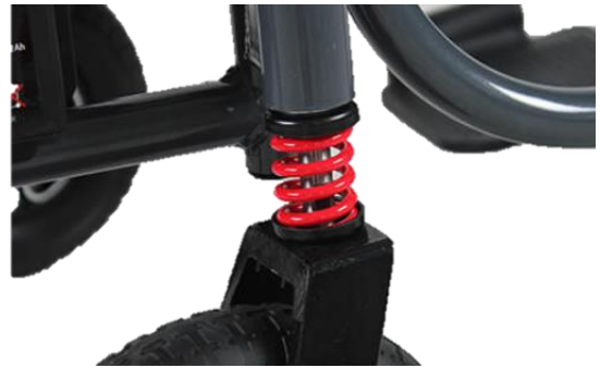
Figura 42. Resorte de la suspensión delantera de la silla de ruedas de Madesite. Fuente: www.hengzekang.com
