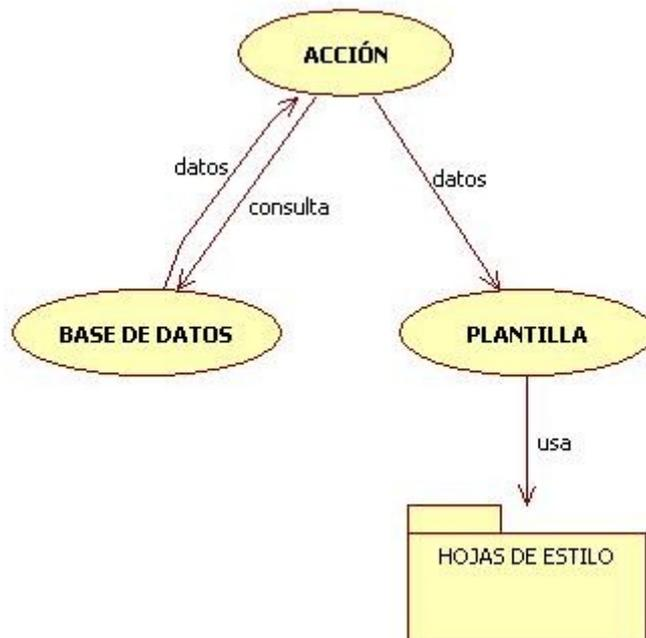
*Ilustración 39: Esquema de flujo de datos en la arquitectura MVC de Symfony*
