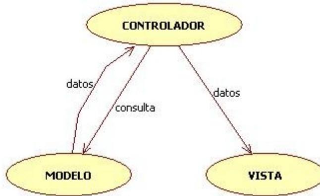
*Ilustración 38: Esquema de flujo de datos en la arquitectura MVC*
