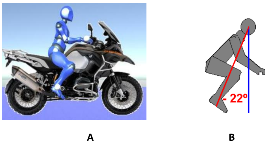
ILUSTRACIÓN 9. A) REPRESENTACIÓN E LA POSICIÓN DEPORTIVA. B) GRADOS DESDE EL EJE VERTICAL DE LA CABEZA DEL PILOTO Y SUS PIES.
