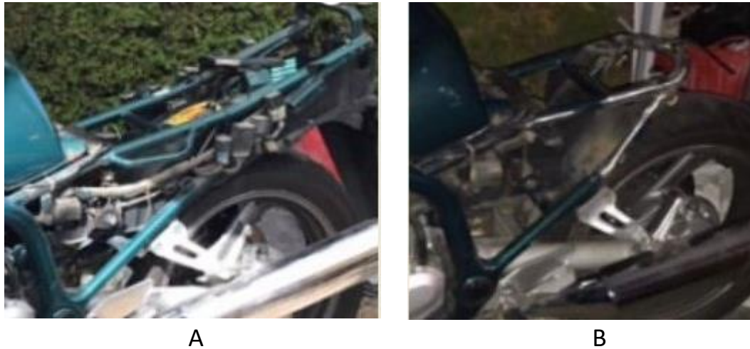
ILUSTRACIÓN 87. A) SUBCHASIS ORIGINAL. B) SUBCHASIS PROTOTIPO DESPUÉS DEL PROCESO DE SOLDADURA.
