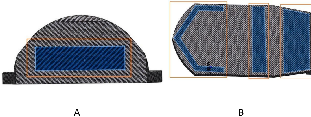
Ilustración 26. a) Línea de partición sujeción vertical. B) Líneas de partición sujeciones horizontales.
