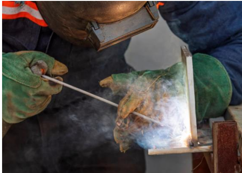
ILUSTRACIÓN 60. PROCESO DE SOLDADURA POR ARCO CON ELECTRODO REVISTIDO.
