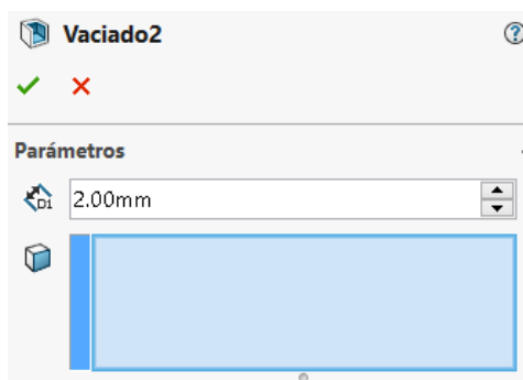
ILUSTRACIÓN 32. FUNCIÓN DE VACIADO CON ESPESOR 2MM.
