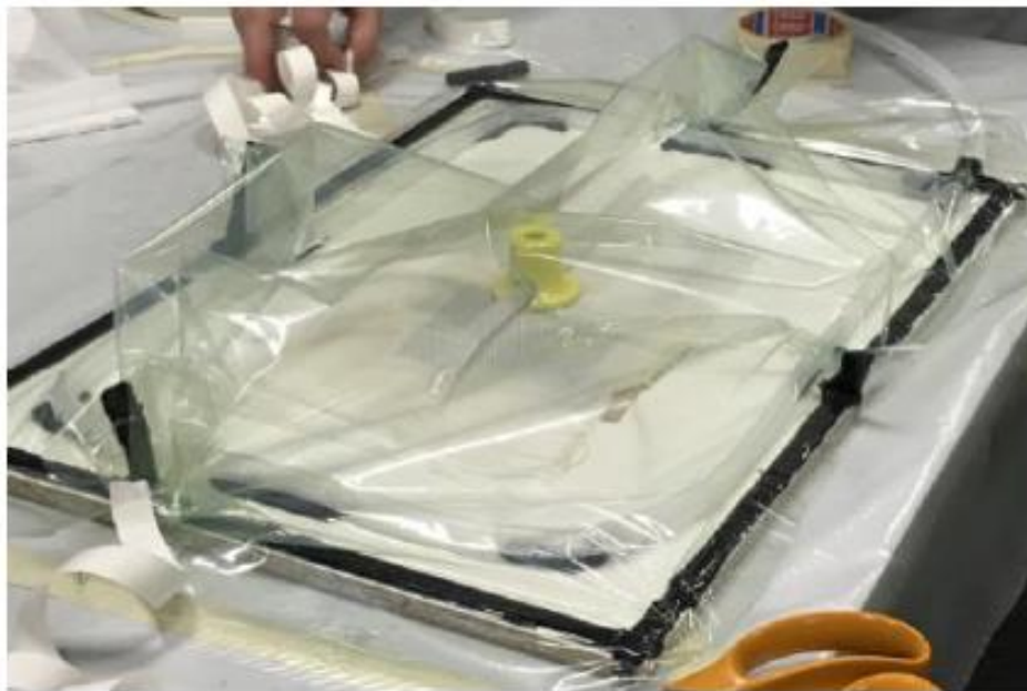
ILUSTRACIÓN 94. RESULTADO FINAL PARA EL PROCESO VARTM.
