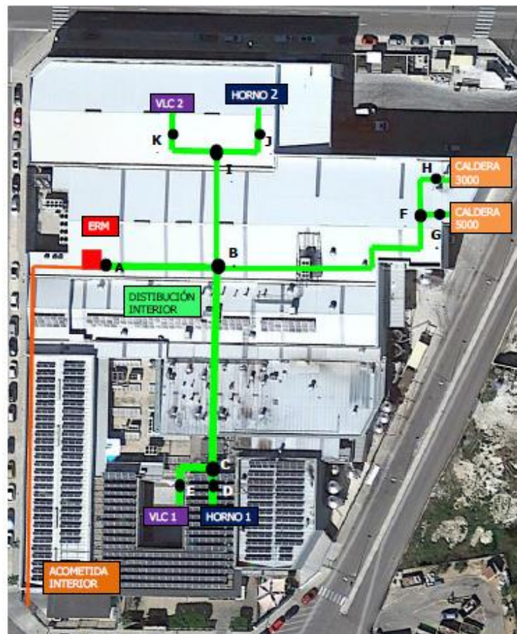
Ilustración 20 Fotos del emplazamiento de la Instalación
