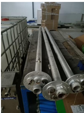
Ilustración 12 Foto tubo quemadores
