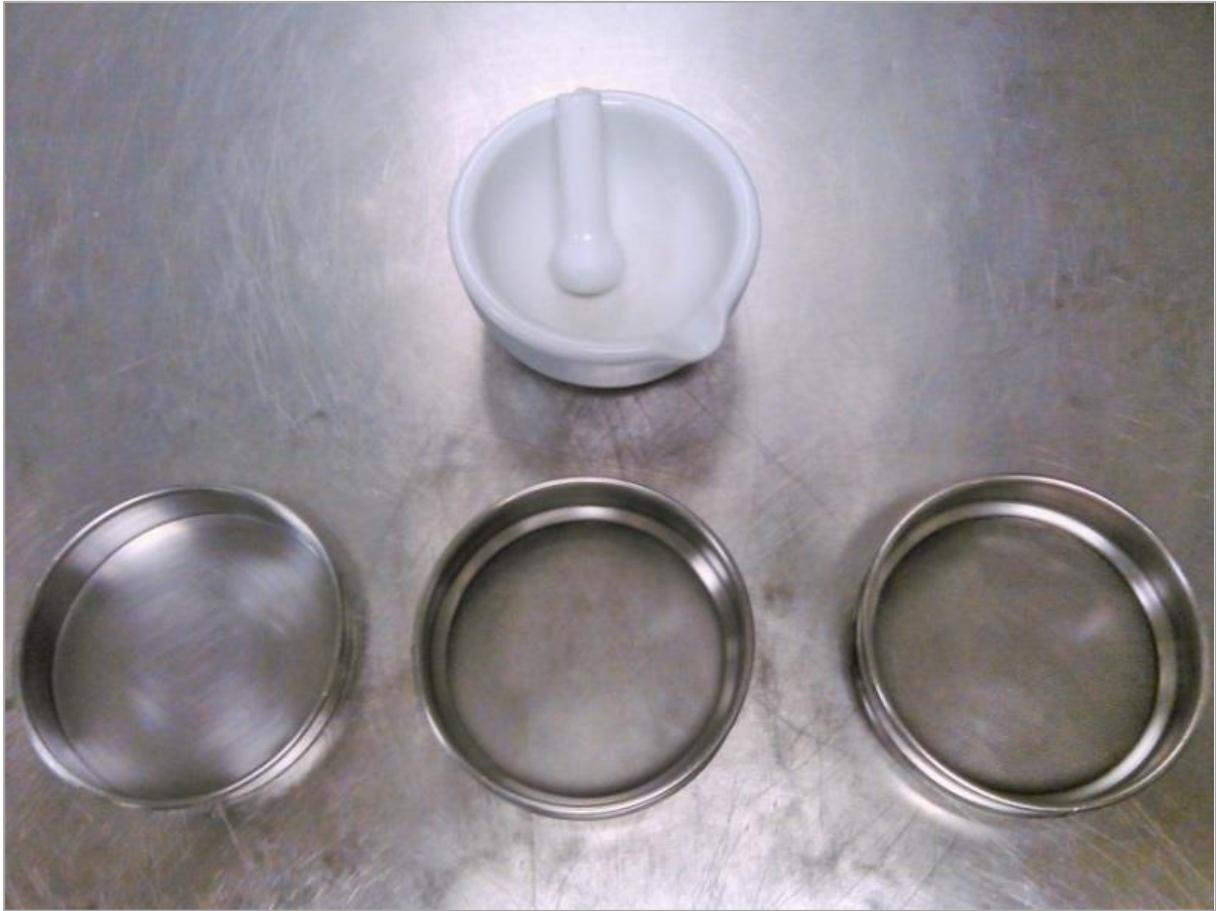
Figura 9. Mortero y tamices utilizados en el procedimiento de tamizado.
