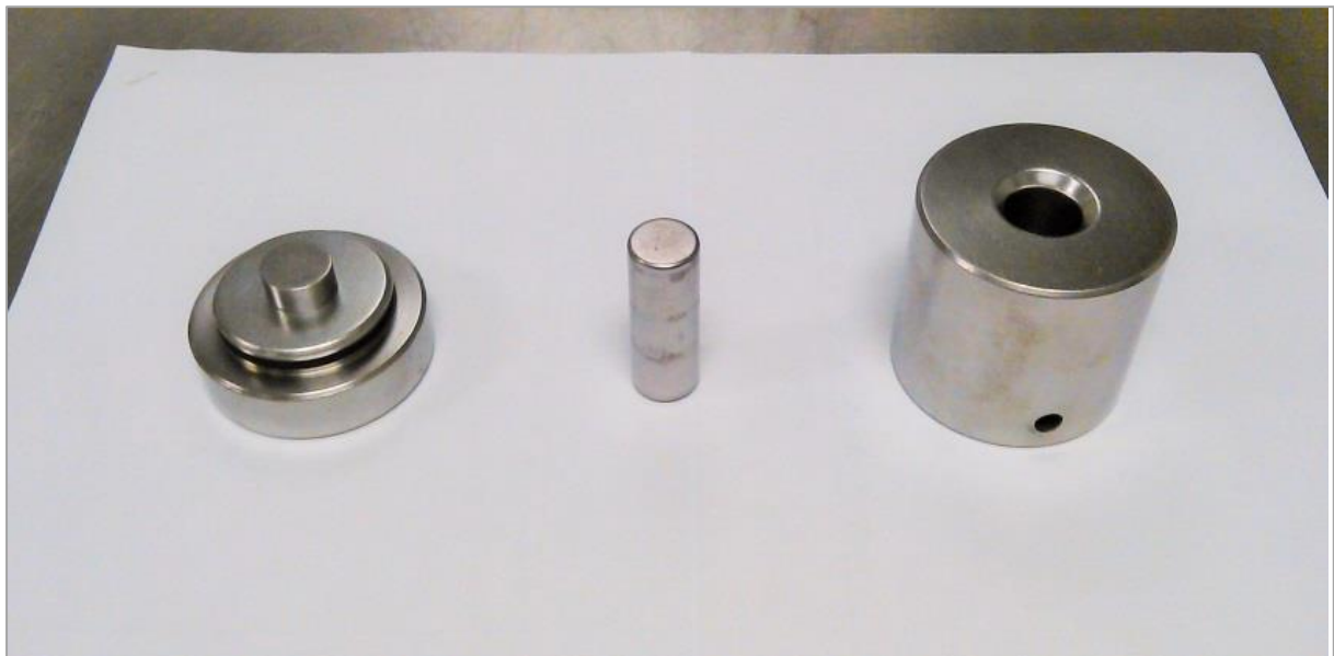
Figura 8. Sistema de troquel utilizado para el empastillado.
