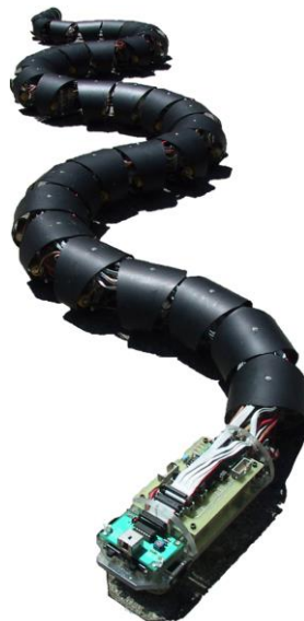
Figura 2.15: Prototipo S5, Gavin Miller ( Fuente: snakerobots.com )
