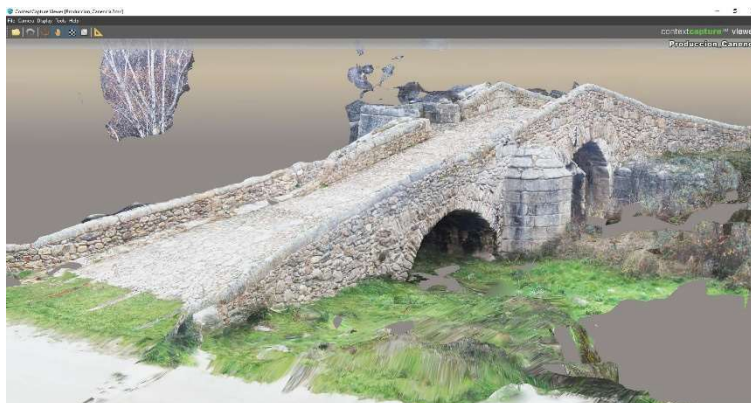
Fig.6 Malla texturizada del Puente de Canencia en ContextCapture
