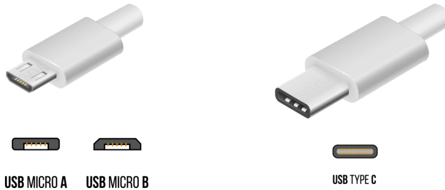
Figura 32. Comparativa física entre USB micro-B y USB tipo C (Dreamstime).
