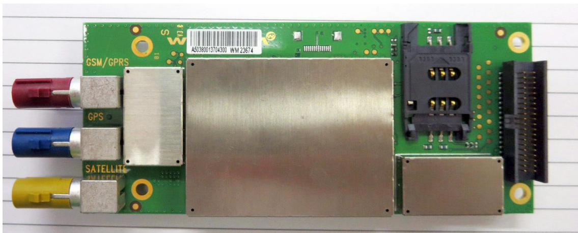
Figura 15. Parte superior de la tarjeta Wavecom Q52 Omni (Elaboración propia).
