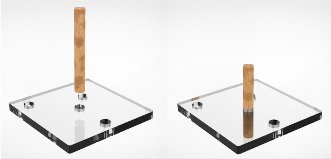
*Figura 47. Proceso de ensamblaje en los módulos de metacrilato en agujeros pasantes.*
