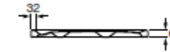
Ref. 373581..0 1000 x 800 x 65 mm. Plato de ducha extraplano, de porcelana. Totalmente compatible con gama de mamparas Roca.
