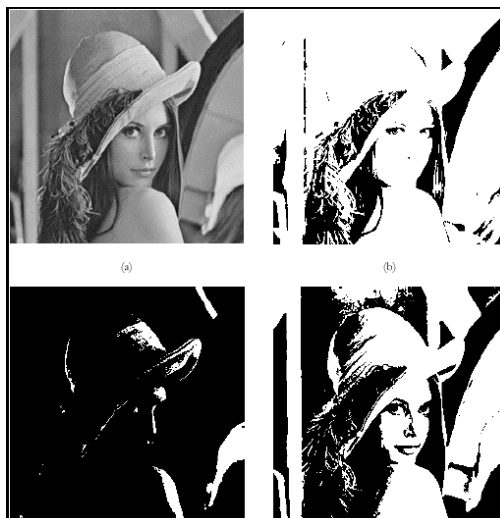
Figura 7. Comparación diferentes valores de umbral. (Sup. Izq) Imagen Control, (sup dch) Imagen Umbral bajo, (inf izq) Imagen Umbral alto e (inf dch) Imagen Umbral medio
