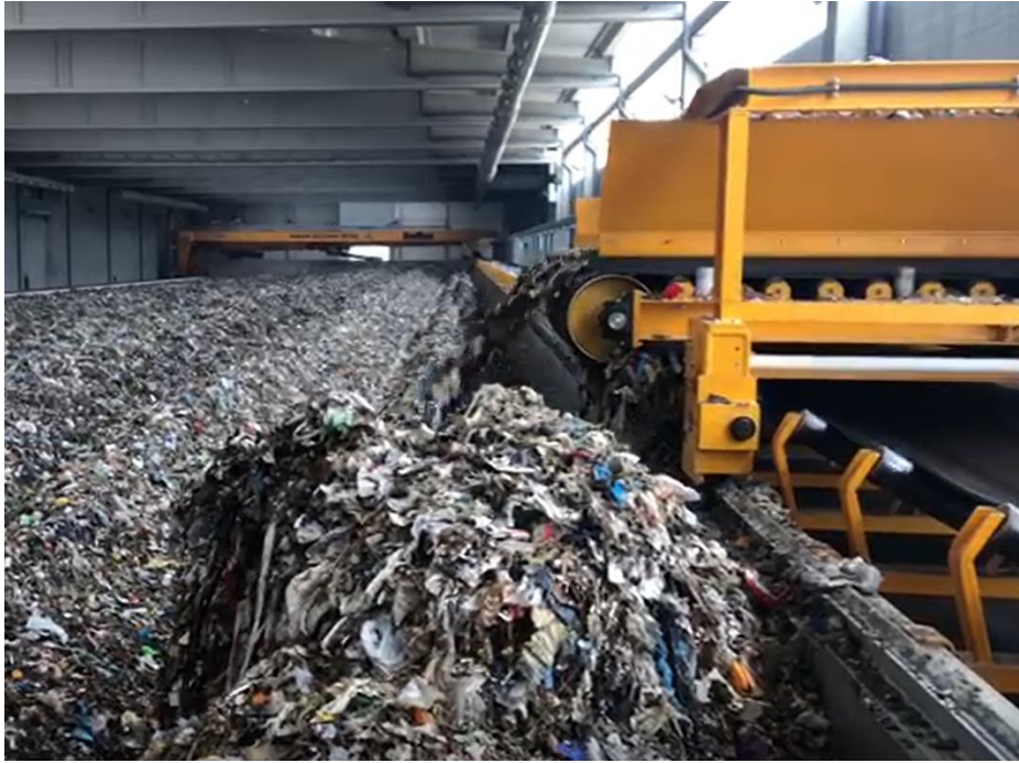
Imatge 37. Equip de descàrrega MOR/FOS en reactor de fermentació (Font: Elaboració pròpia)
