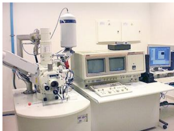
Figura 10. Microscopio JEOL 6300 y detector de rayos X Oxford LINK ISIS de la UPV. [69]
