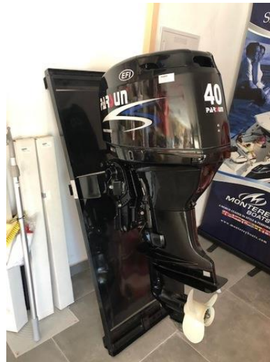
Figura I.4.- Motor fueraborda con un sistema de engranajes que permiten el cambio de posición y poder sacarlo del agua cuando la embarcación está parada.
