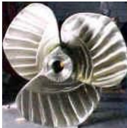
Figura I.12.-. Hélice de paso variable conseguido gracias a un diseño ondulado de las caras del álabes
