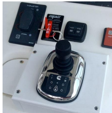
Figura I. 5.- Dispositivo de control de dirección, característico de un motor intraborda Pod Drive
