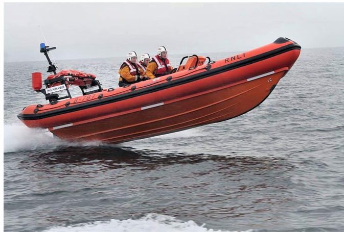
Figura I.1.- Lancha semirrígida utilizada por guardacostas. Se puede observar como el casco es metálico mientras que en los extremos de la cubierta tiene flotadores
