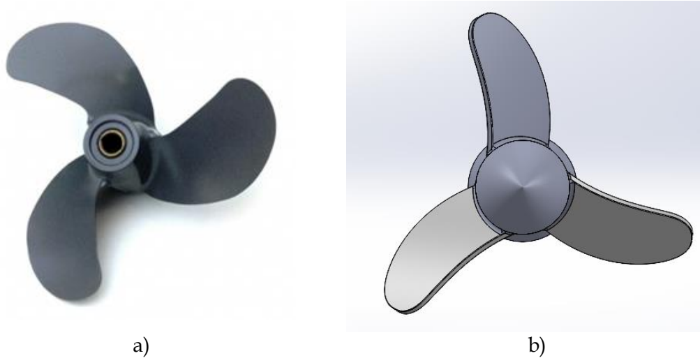
Figura III.9. a) Imagen de la hélice suministrada por Honda para su motor BF5A. b) Vista frontal del diseño del modelo inicial de la hélice.
