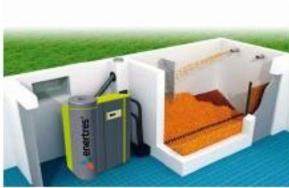
Ilustración 3.1. Simulación realista de la disposición de la caldera y el silo
