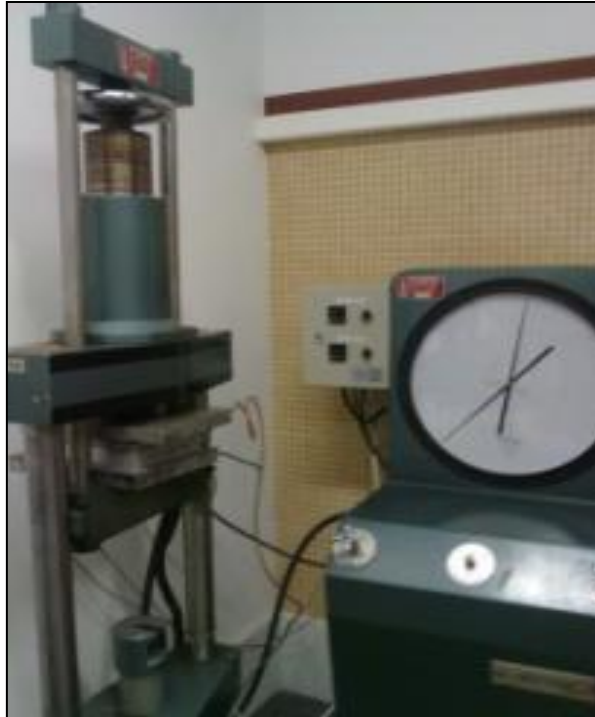
Figura 18. Prensa con platos calientes utilizada para la fabricación del material
