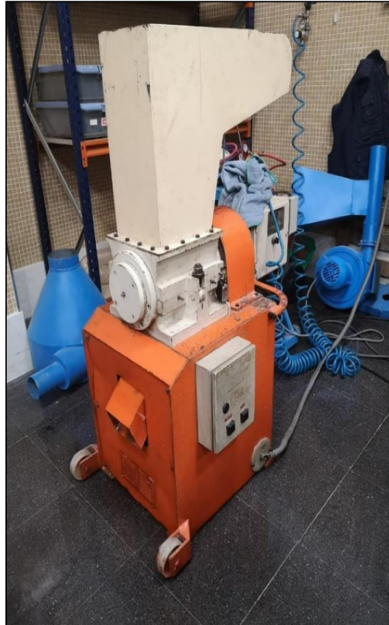
Figura 17. Molino triturador utilizado disponible en el departamento de Ingeniería Mecánica y de Materiales de la Escuela Politécnica Superior de Alcoy
