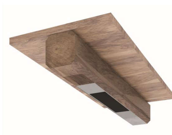
Figura 44. Refuerzo a flexión mediante aplacado con lámina de fibra de carbono.
