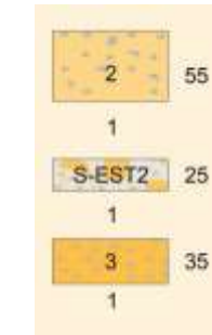
Figura 1. Formación de explanada. Fuente: Norma 6.1 IC
