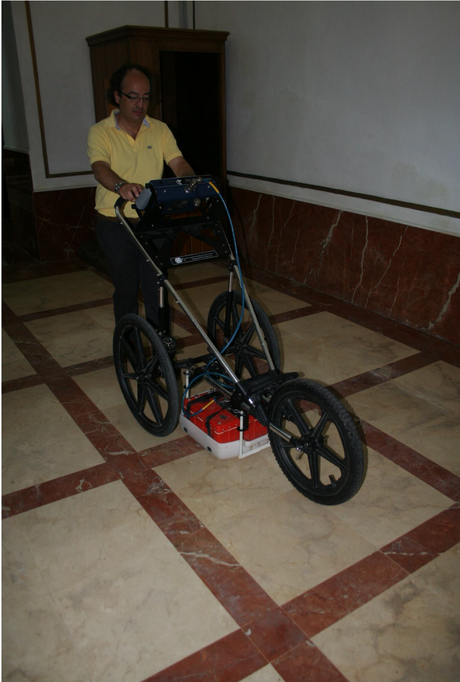
Fotografía de la toma de datos mediante el instrumento de georadar.
