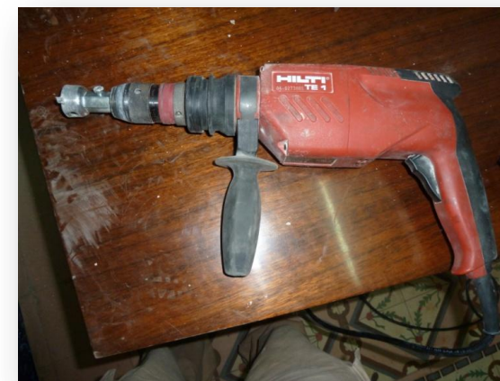
Imagen de la taladradora utilizada con el accesorio de la corona de diamante para extracción de probetas.
