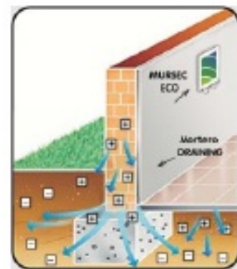
Dibujo 2: Circulación del agua tras la inversión de la polaridad.
