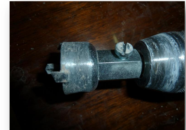
Imagen de la taladradora utilizada con el accesorio de la corona de diamante para extracción de probetas.
