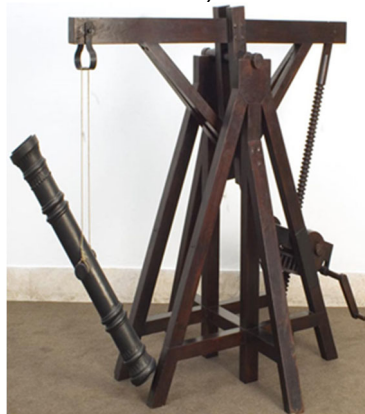
Figura 3.6 Maqueta de Cabestrante (realizada por Argan Giovanale), para elevar cañones y columnas (según diseño de Leonardo) del Museo de la Ciencia y Tecnología de Milán ( http://www.museoscienza.it/dipartimenti/catalogo_collezioni/scheda_oggetto.asp?idk_in=ST070-00061&arg=Modelli%20leonardeschi ).
