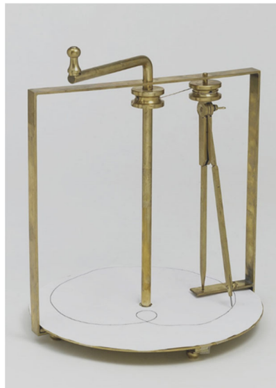
Figura 8.7 a) Compás epicicloide Códice Arundel f. 160v. ( http://www.bl.uk/manuscripts/Viewer.aspx?ref=arundel_ms_263_f001r ), b) Reconstrucción en latón del Instituto y Museo de Historia de la Ciencia de Florencia ( https://brunelleschi.imss.fi.it , Museo Galileo, Florencia).
