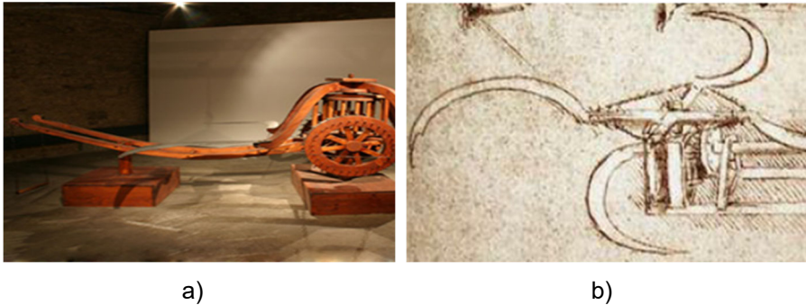
Figura 6.4 a) Maqueta del Carro de Guerra (Biblioteca Real de Turín) ( http://www.macchinedileonardo.com/index0aec.html?le-macchine ), b) Detalle del final del árbol de transmisión a las guadañas delanteras.
