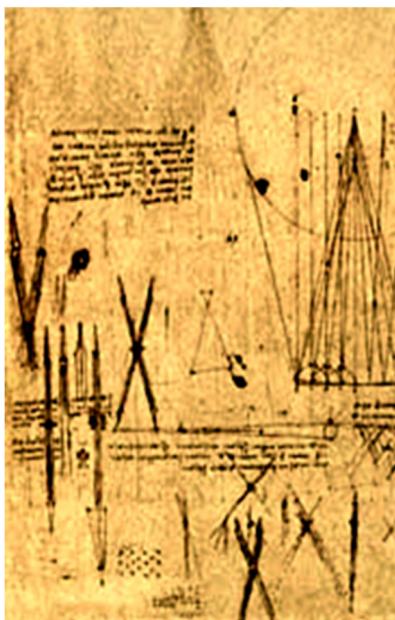
Figura 8.3 a) Compás de proporción de tornillo, y detalle de su tuerca, Códice Forster Ms. I, c. 4r. ( https://commons.wikimedia.org/wiki/File:Reduction_Compass_Leonardo.jpg ), b) Detalle compás proporcional de varillas, Códice Atlántico f 1046r ( https://commons.wikimedia.org/wiki/File:000R-1046.jpg?uselang=es-formal ), c) Compases de reducción, Códice Atlántico f 672r ( https://commons.wikimedia.org/wiki/File:Codex_Atlanticus_-_000R-672.jpg?uselang=es-formal ).
