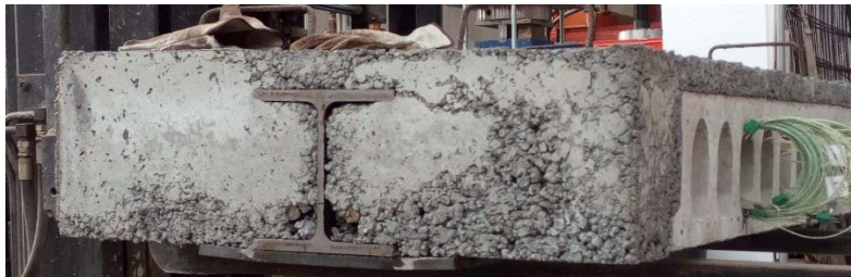
Figura 4-21 Viga A4 tipo SFB relleno con HL30.
