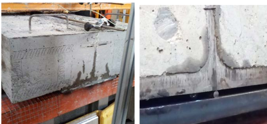
Figura 4-45. Exudación de vapor y goteo de agua durante el ensayo.
