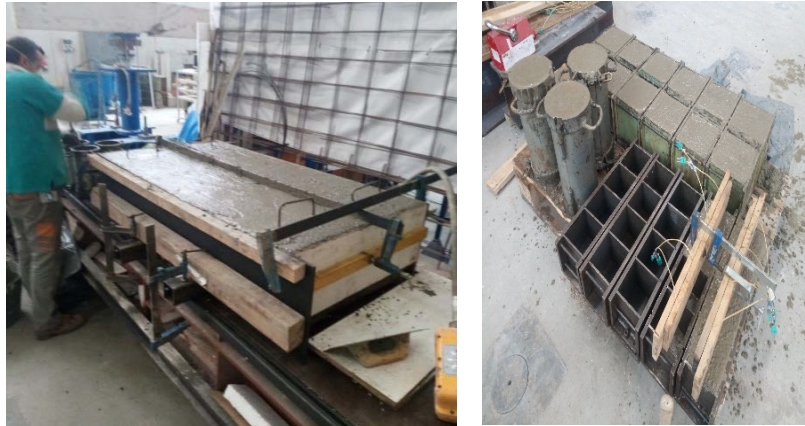
Figura 4-8 Viga hormigonada y fratasada, (izq.) relleno de moldes (der.)
