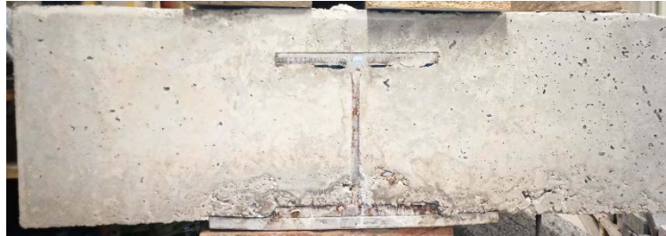
Figura 4-22 Viga A5 con chapa de acero inoxidable.
