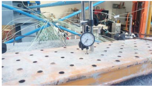
Figura 4-41. Preparación del ensayo. Colocación del reloj comparador de posición.
