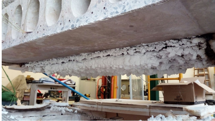
Figura 5-9 Reacción de la pintura intumescente. Ensayo A6.
