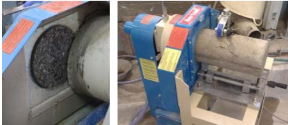
Figura 4-9 Detalle y vista general del equipo de refrentado.
