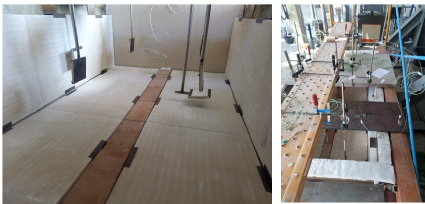
Figura 4-37 Disposición de termopares de placa para horno.
