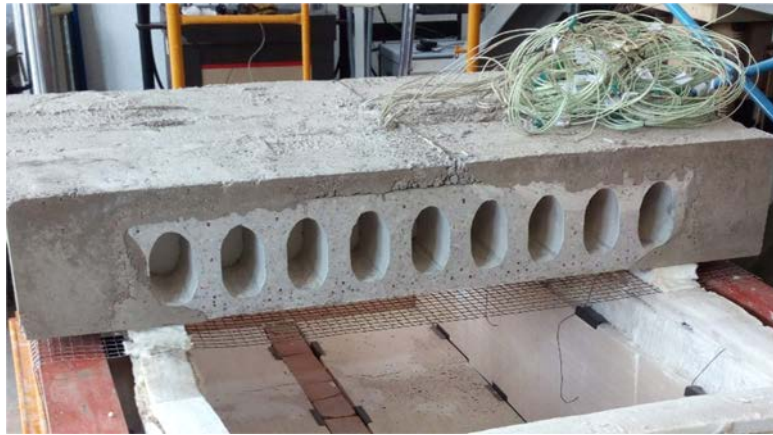
Figura 4-39. Colocación de la muestra de ensayo en el horno.
