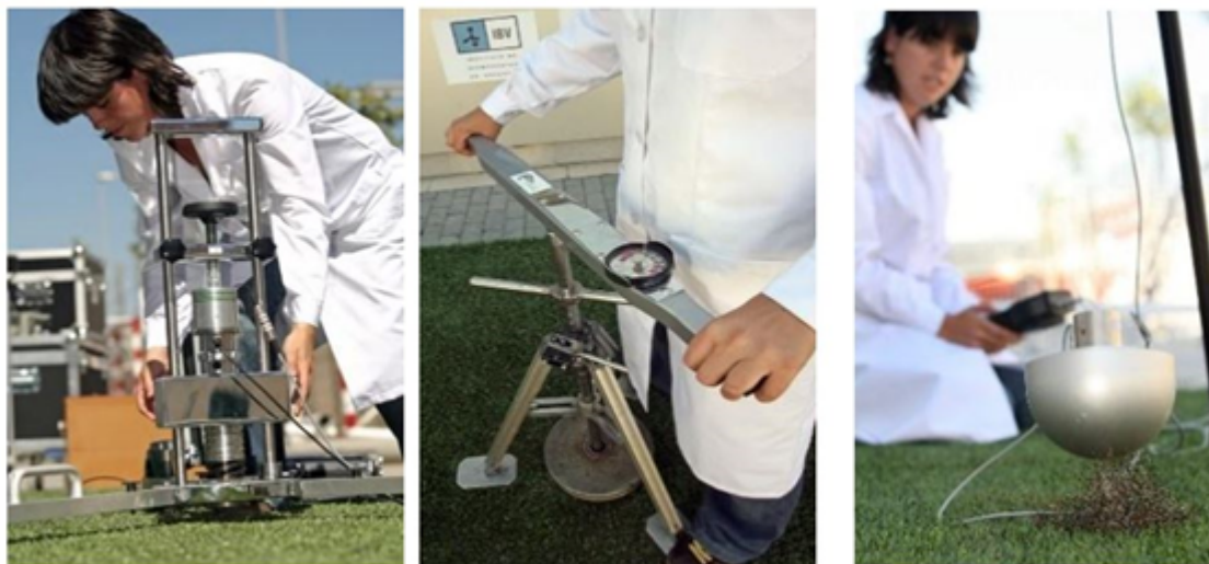
Figura 2. Evaluación de la interacción jugador-césped deportivo (amortiguación, giro e impacto de cabeza).
