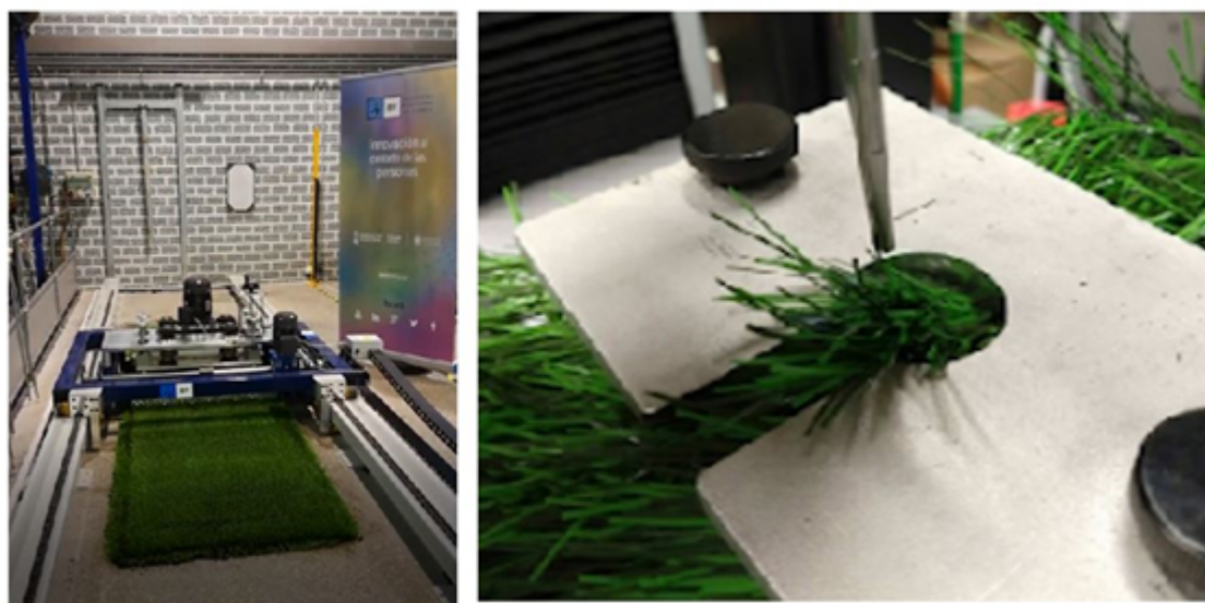
Figura 3. Evaluación de la resistencia y durabilidad frente a diferentes agentes y condiciones (simulación de desgaste y extracción de fibras).
