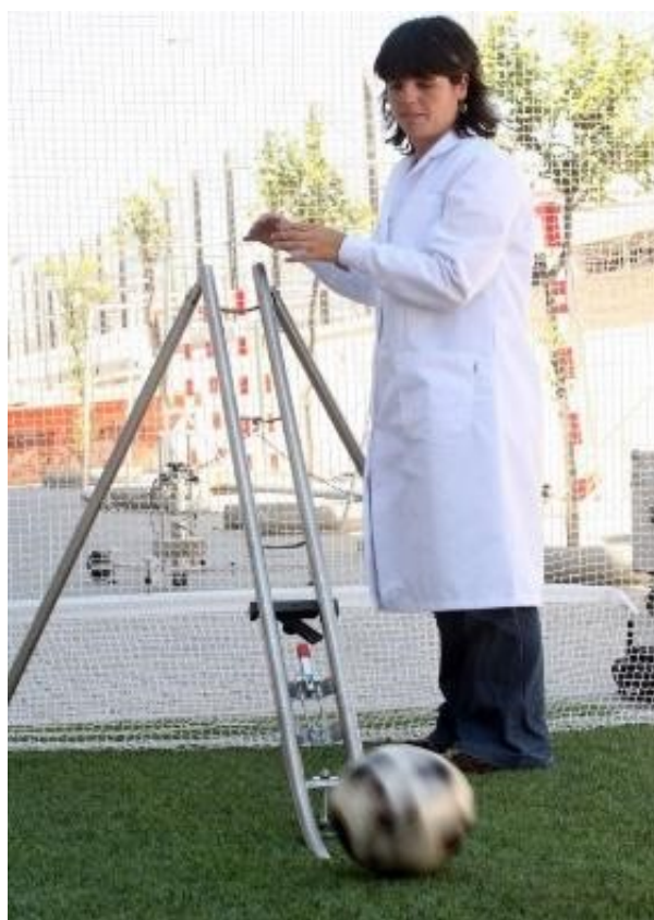
Figura 1. Evaluación de la interacción balón-césped deportivo (ensayo de rodadura).
