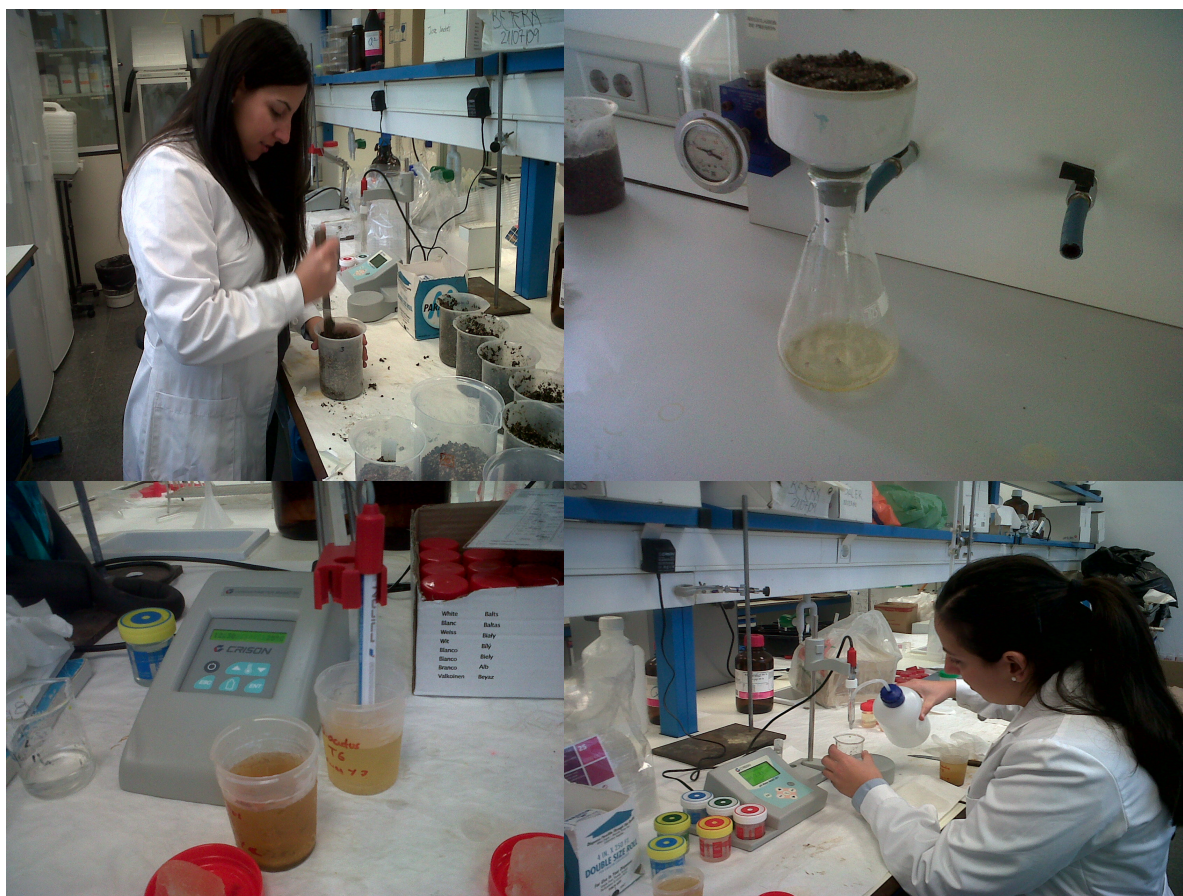
Figura 19: removiendo pasta saturada (arriba izquierda), muestra en el embudo Buchner aplicando el vacío (arriba derecha), lectura extracto con el conductímetro (bajo izquierda) y lectura del pH del extracto (bajo derecha).
