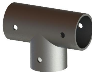
Fig. 19. Render de la pieza 1.1.1.1.6 Pieza unión T.
