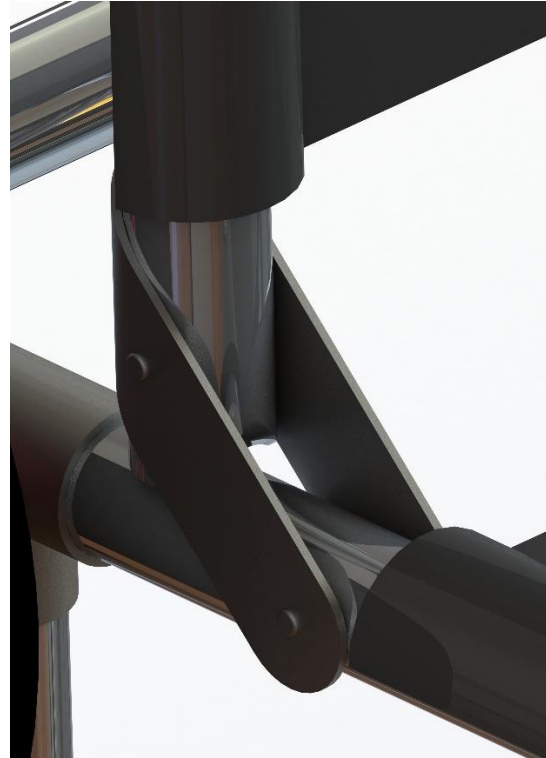
Fig. 16. Render unión: barra asiento + barras respaldo.
