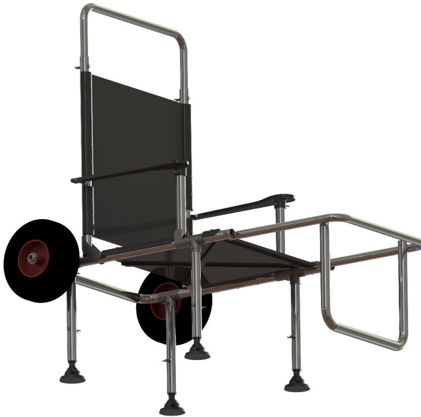
Fig. 4. Render de la silla sin textil y almacenamiento. Vista inferior.
