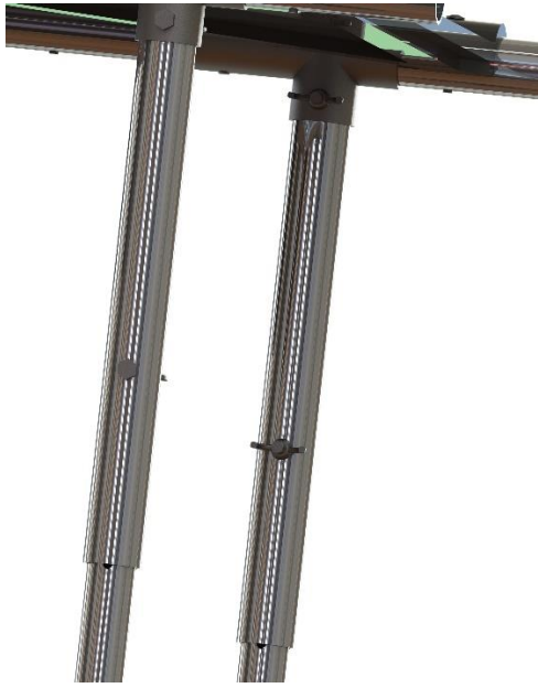
Fig. 23. Render unión: barras patas y patas + barra asiento.
