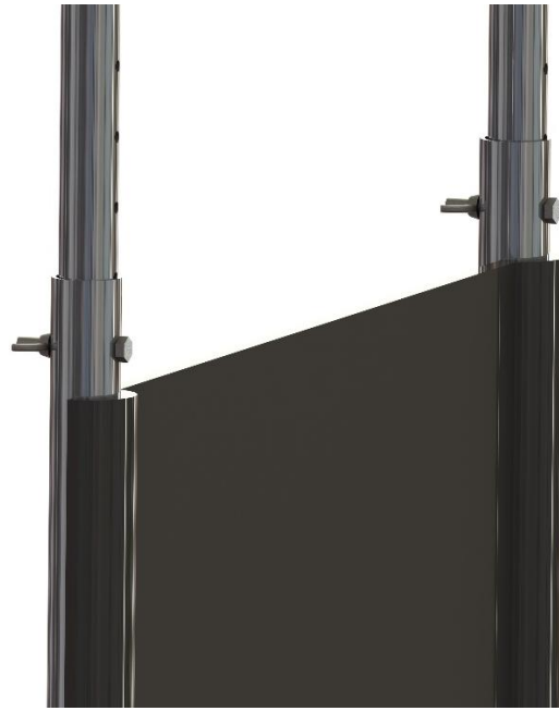
Fig. 20. Render unión: barra respaldo + asa-reposacabezas.
