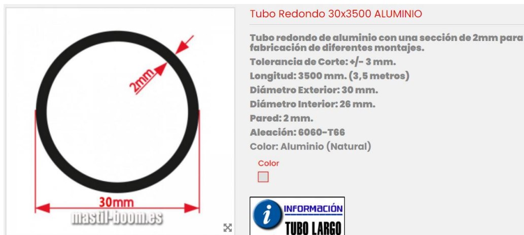
Fig. 9. Tubo redondo de aluminio 30 x 3500 x 2 mm.
