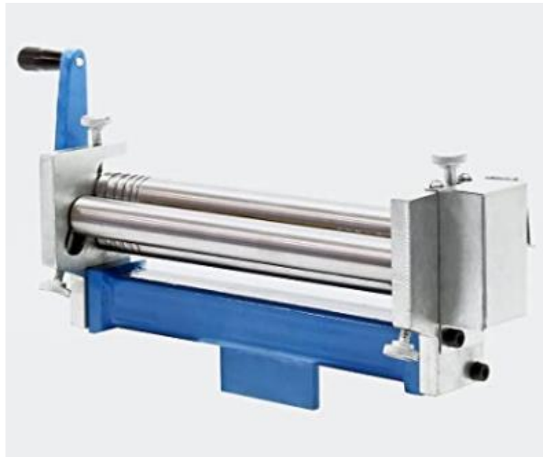
Fig. 7. Máquina curvadora de chapa de 3 rodillos.
