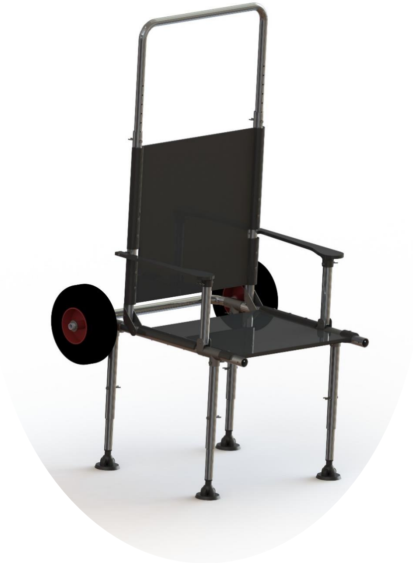
Fig. 7. Render de la silla sin reposapiés, textil y almacenamiento.
