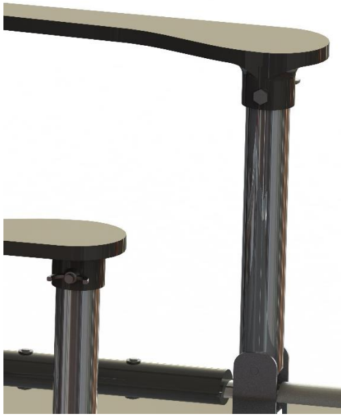
Fig. 19. Render unión: barra reposabrazos + tabla reposabrazos.
