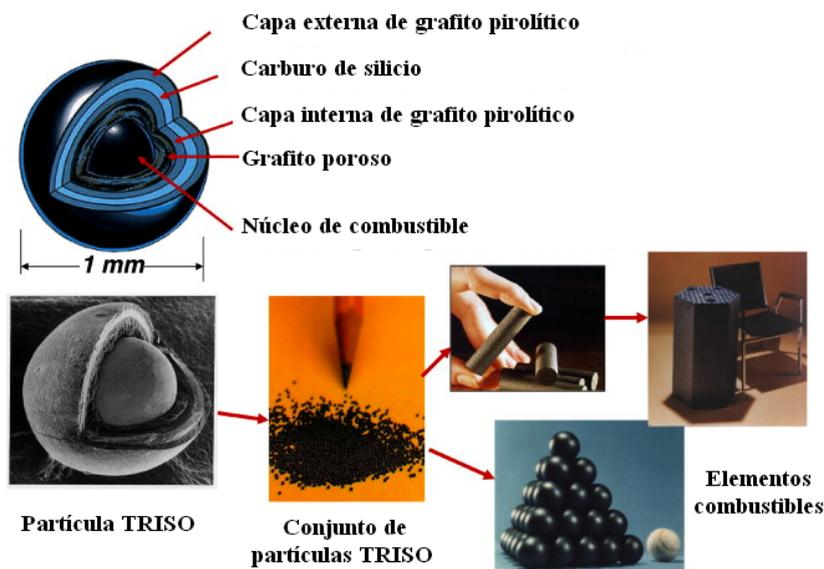
**Figura 1.2: Estructura del combustible basado en partículas TRISO (Olander, 2009).**
