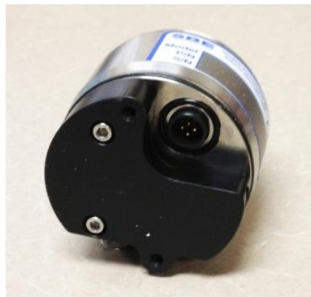
Figura 5 Sensor SBE 63 de oxígeno disuelto.
