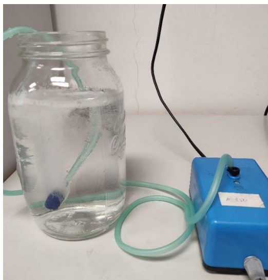
Figura 7 Método utilizado para realizar muestras a 100 % de oxígeno disuelto utilizando un aireador.
