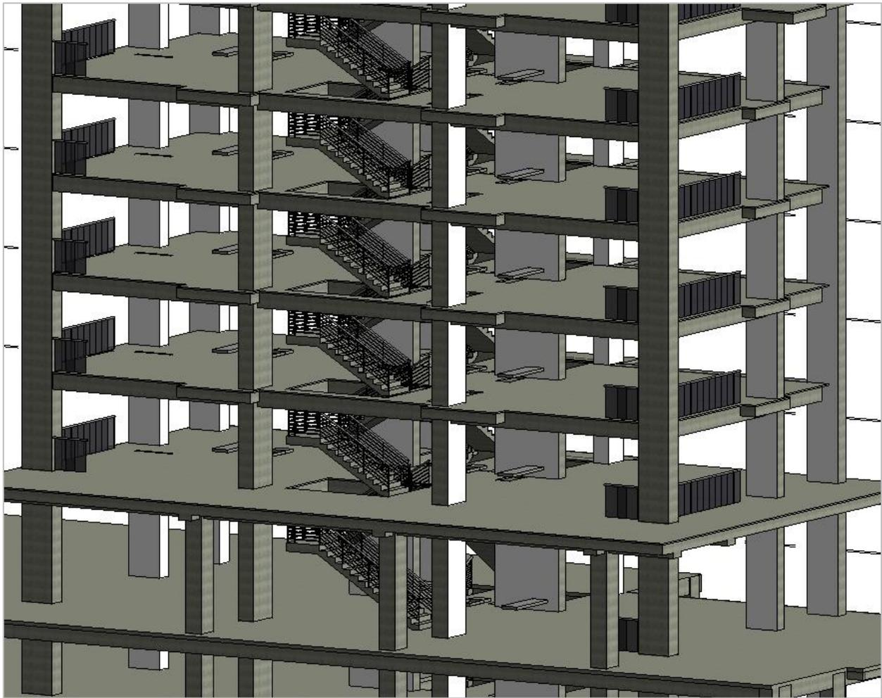
**Ilustración 27** Vista en 3D del modelado de escaleras con sus respectivas barandillas. Niveles: 1-2-3-4-5-6
