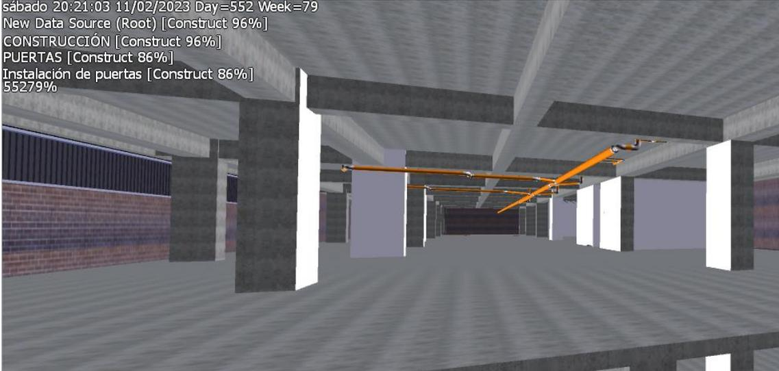
**Ilustración 54** Visualización de la fase final de la instalación de redes hidrosanitarias y acabados en la simulación 4D. (96% avance de obra).
