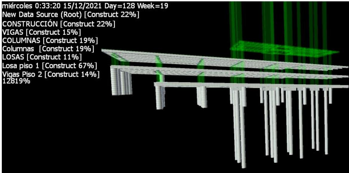
*Ilustración 51* Visualización de la fase de construcción de vigas y losas niveles sótano 1 y 2 en la simulación 4D (22% de avance de obra).
