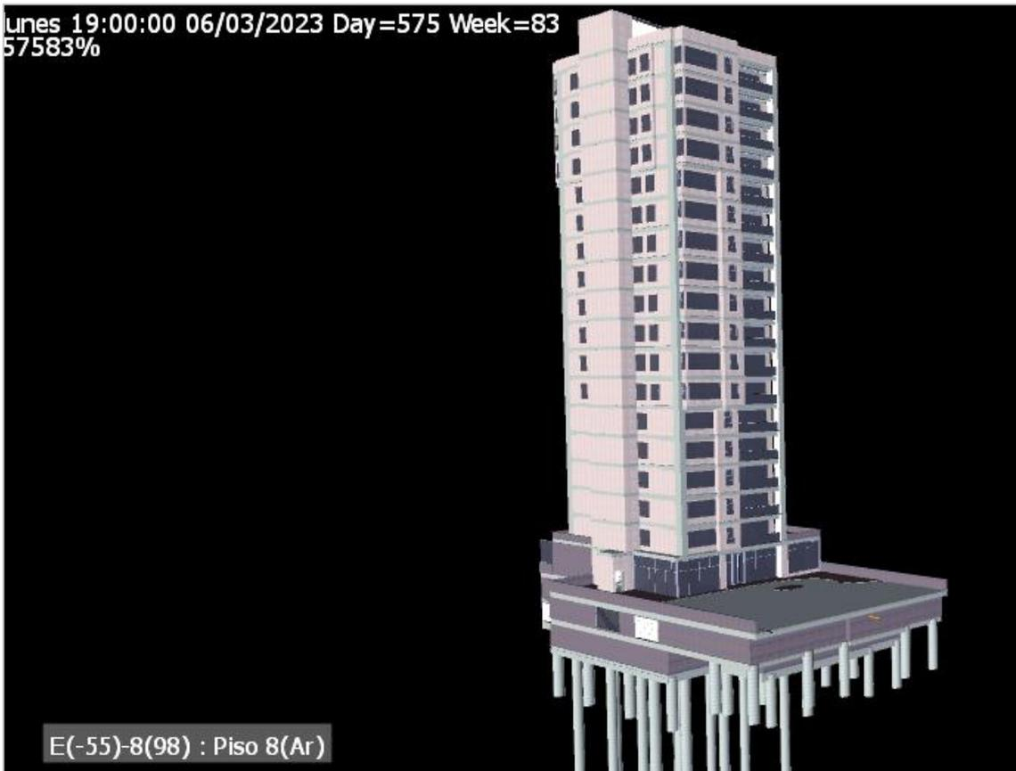
**Ilustración 55** Visualización final del proyecto construido en la simulación 4D. (100% avance de obra).
