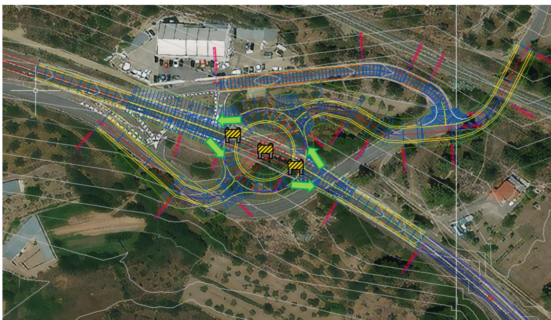
Imagen 3. Circulación por el anillo para la construcción de la zona central.
