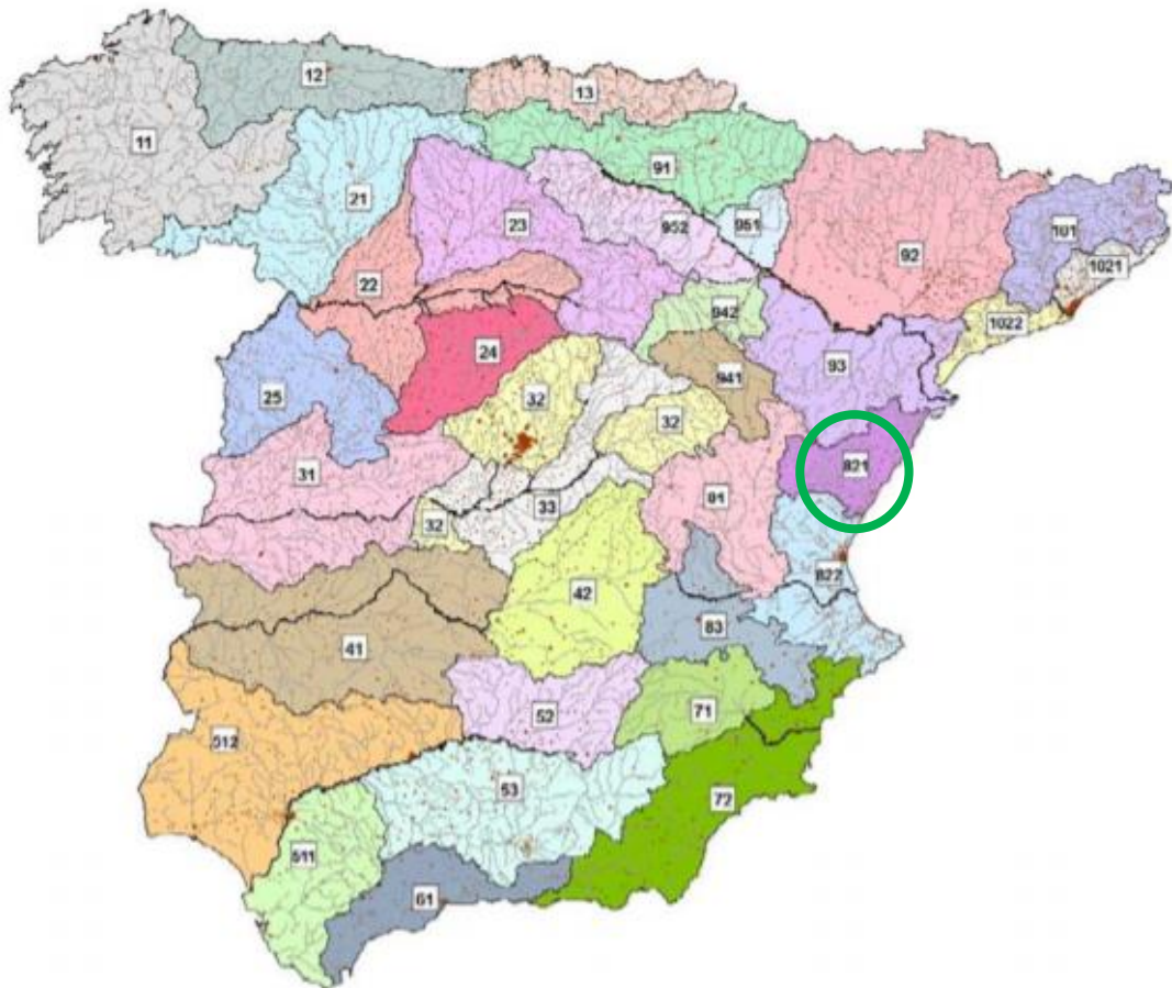
Imagen 14. Regiones para obtener el coeficiente \beta .
