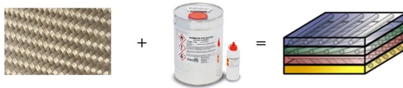
Figura 1.1. Ejemplo de componentes: tejido (refuerzo) + resina (matriz polimérica).
