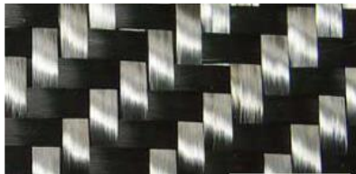
Figura 1.5. Tejido de refuerzo de fibra bidireccional y refuerzo roving.
