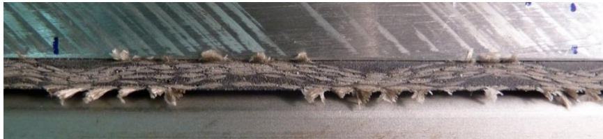
Figura 4.23. Delaminado con distribución irregular de la fibra y la resina.
