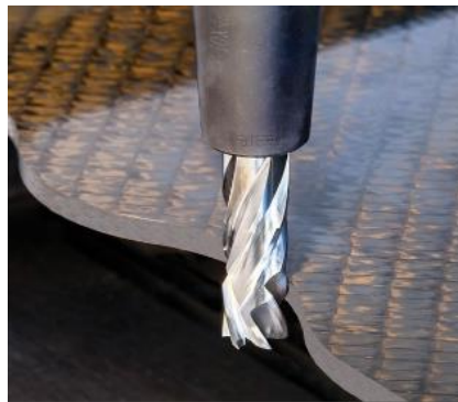
Figura 1.14. Contorneado o “edge trimming” [24].
