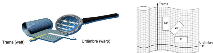
Figura 1.6. Trama y urdimbre de un tejido bidireccional [1].
