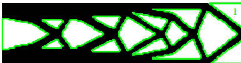
Figura 22. Cavidades en una viga Cantilever. Fuente: Brackett et al. [26] .
