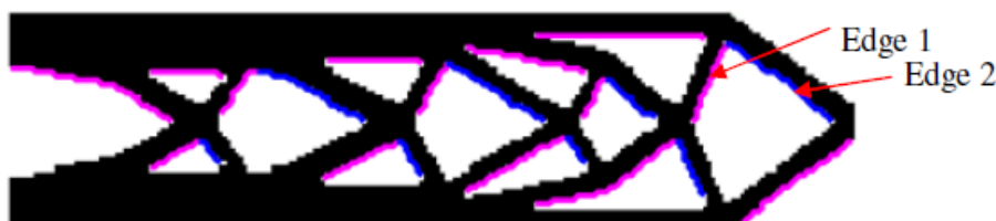
Figura 23. Contornos interiores de las cavidades. Fuente: Brackett et al. [26] .
