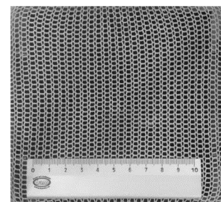
Ilustración 32. Tejido usado para la cimbra perdida del puente.
