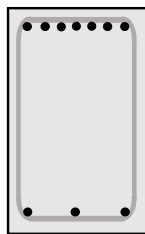
Figura 48. Sección transversal de los elementos viga en empotramiento.
