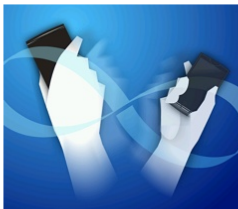
Figura 97: moviment de calibratge ràpid del magnetòmetre d'un smartphone
