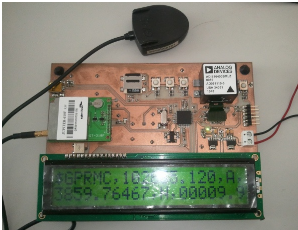
Figura 148: Prototip de la Implementació amb un PIC24FJ256GB106 mostrant la nostra localització en l'instant de la fotografia.
