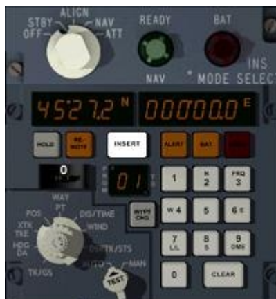
Figura 59: Detall d'una de les parts de control del sistema de navegació inercial Delco Carousel
