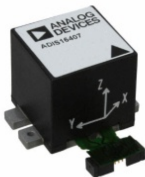
Figura 47: ADIS 16407: sensor MEMS de 10 graus de llibertat,
