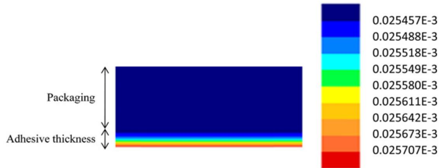
Figura 4.15 Sección transversal del sensor mostrando las deformaciones en el eje X. Espesor de adhesivo 100 \mu\text{m} . Coeficiente de Poisson del adhesivo \nu_A=0.4 .
