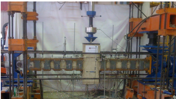
Figura 9. Imagen del nudo en el pórtico de ensayo.
