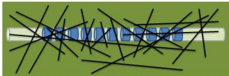
Figura 4.24. Aleatoriedad de los pelos de la fibra de vidrio sobre la red de difracción de Bragg del sensor.
