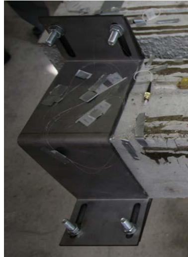
Figura 7.12 Imagen del refuerzo propuesto en las cabezas de las probetas.
