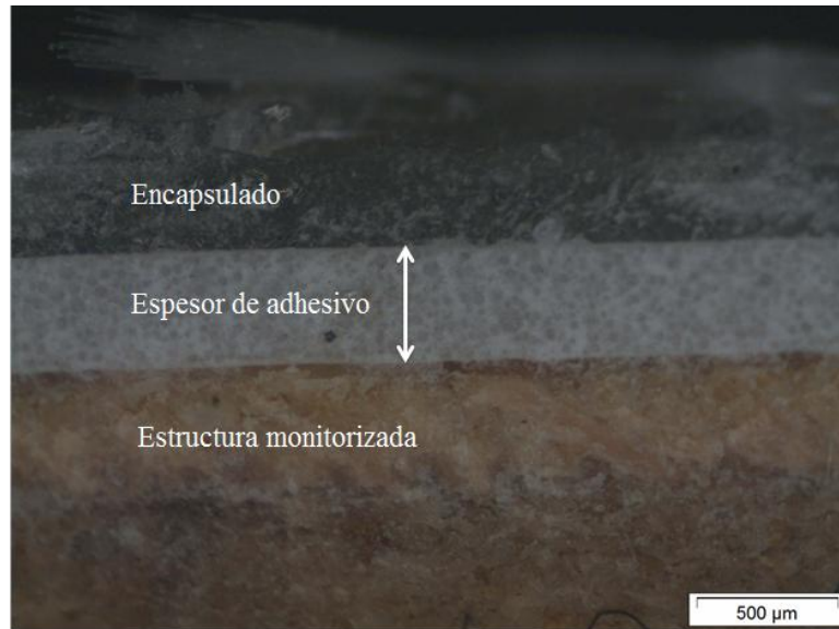
Figura 4.17 Sección transversal del sensor adherido a una superficie. La imagen fue tomada con un microscopio de alta resolución StereoZoom SZ61 (Altra, 1999) y procesada con el software AnalySIS getIT Olympus (Olympus, 2006).
