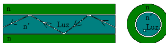
Figura 2.2 Modo de viaje de la luz a través de la fibra óptica (www.Wikipedia.es).
