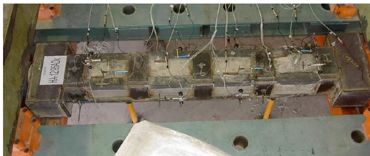
Figura 1.3 Pilar instrumentado con galgas extensométricas (Adam 2007).
