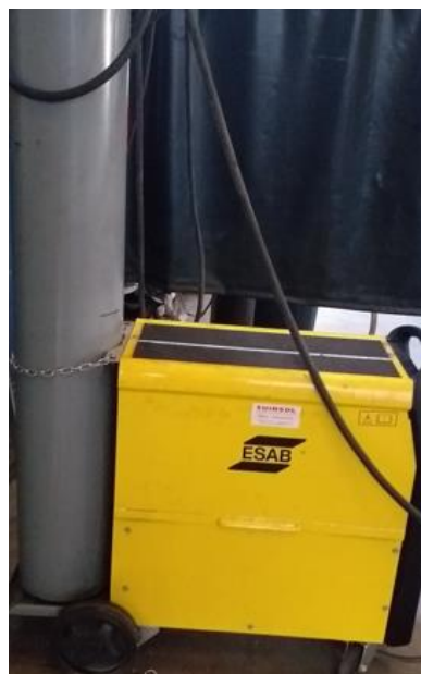
Imagen 17. Equipo soldadura. Fuente: Datos empresa. Elaboración propia
