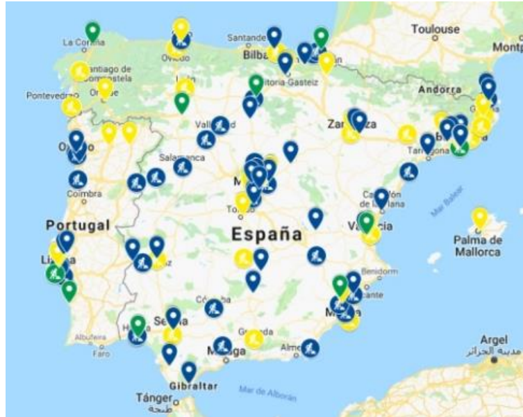
Figura 3. Distribución estaciones de carga de GNL y GNC en España (GN Fenosa, 2021)
