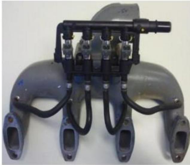
Figura 30. Sistema de inyección de hidrógeno en colector de admisión (Oliveira, 2013)
