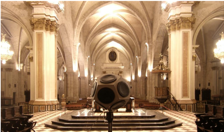
Figura 1. Medición acústica de la Catedral de Valencia.
