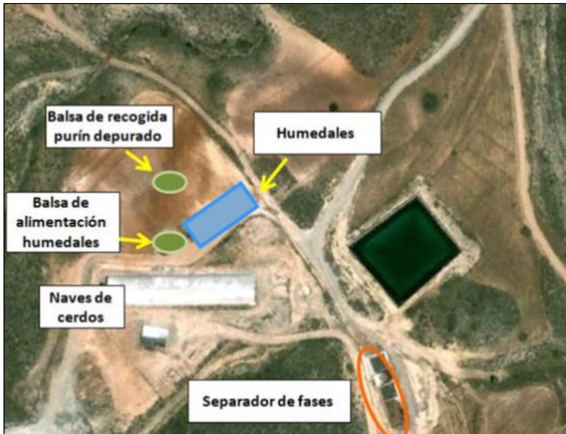
Figura 9. Esquema tratamiento de purines en Murcia. Fuente: MAPAMA, 2015.
