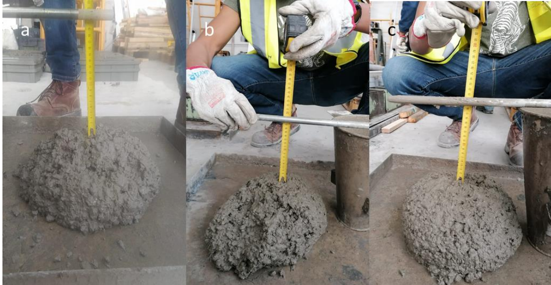
Figura 47. Ensayo de cono de los hormigones OPC a) 0 kg/m 3 , b) 7.5 kg/m 3 , c) 15 kg/m 3
