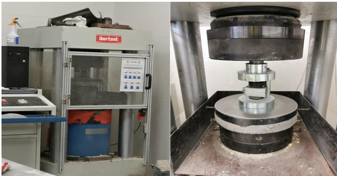
Figura 25. Máquina Iberitest (izq) y accesorio para ensayar morteros a compresión (der).
