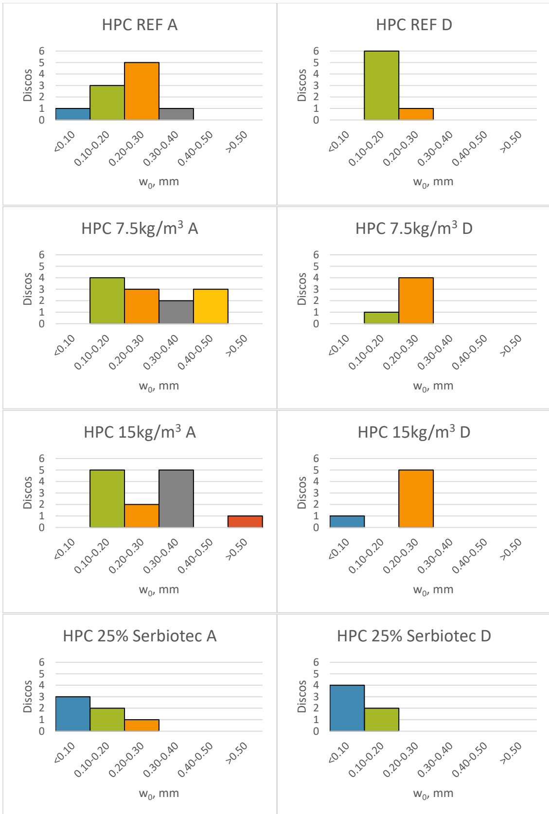
Figura 61. Aberturas de fisura de las series de hormigón HPC A (izq) y HPC D (der)
