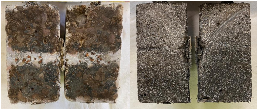
Figura 34. Disco OPC penetrado por cloruros (izq) y disco UHPC no penetrado (der).
