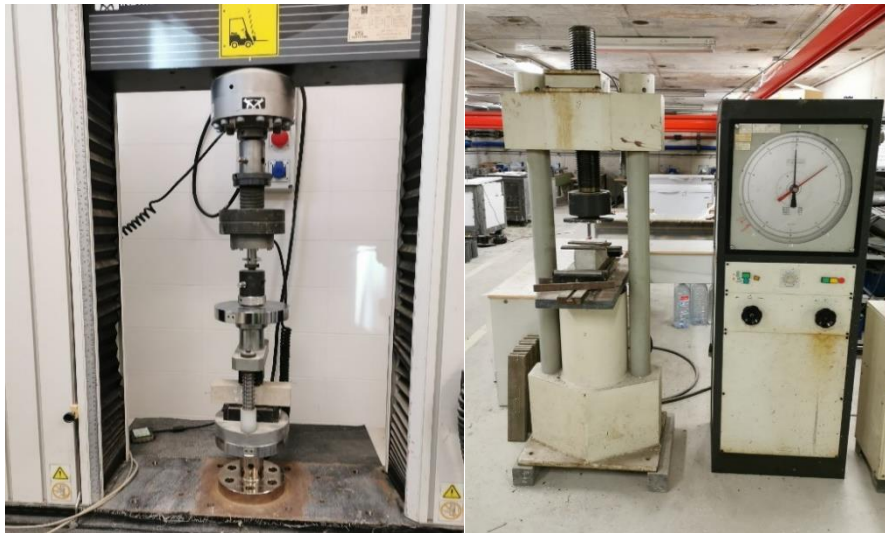
Figura 27. Equipo para prefisurar morteros (INSTRON, izq) y discos de hormigón (Ibertest, der).
