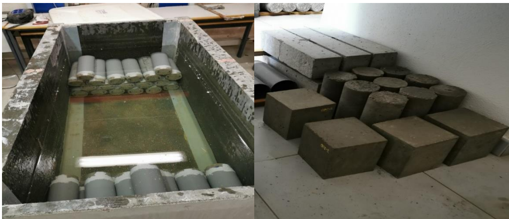
Figura 31. Ambientes de sanado: inmersión en agua (izq) y cámara húmeda (der)
