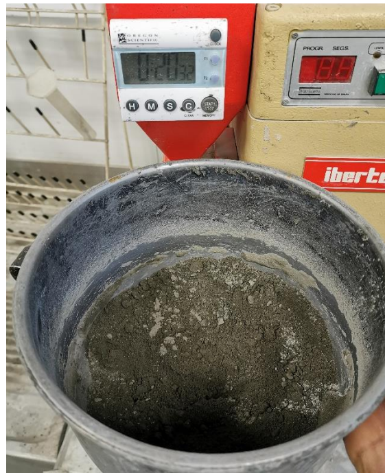
Figura 37. Mortero UHPC con 30 kg/m 3 de Serenade Max, sin reaccionar después del tiempo de amasado.
