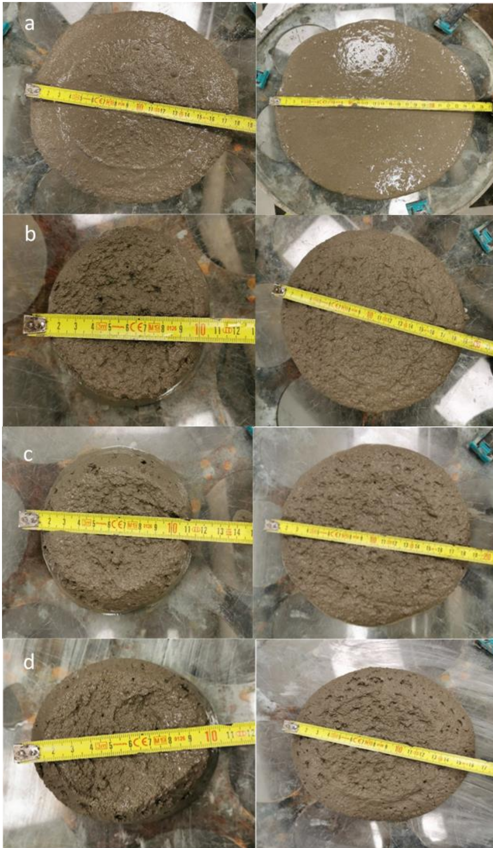
Figura 39. Mediciones del mortero OPC en la mesa de sacudidas antes (izq) y después (der) de los golpes para contenidos de bacteria de a) 0 \text{ kg/m}^3 b) 7.5 \text{ kg/m}^3 c) 15 \text{ kg/m}^3 d) 30 \text{ kg/m}^3
