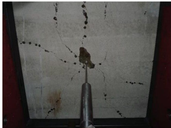
Figura 9. Red vascular en 2D liberando silicato sódico (De Belie et al., 2018).
