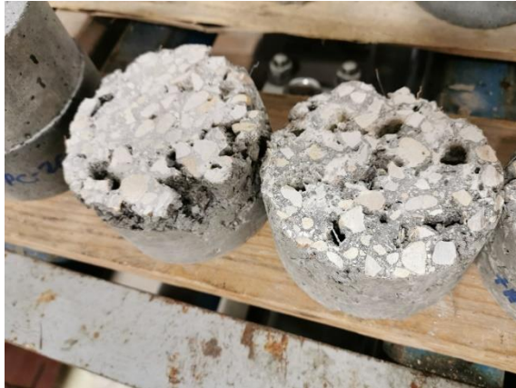
Figura 55. Huecos en la matriz del hormigón HPC-25%
