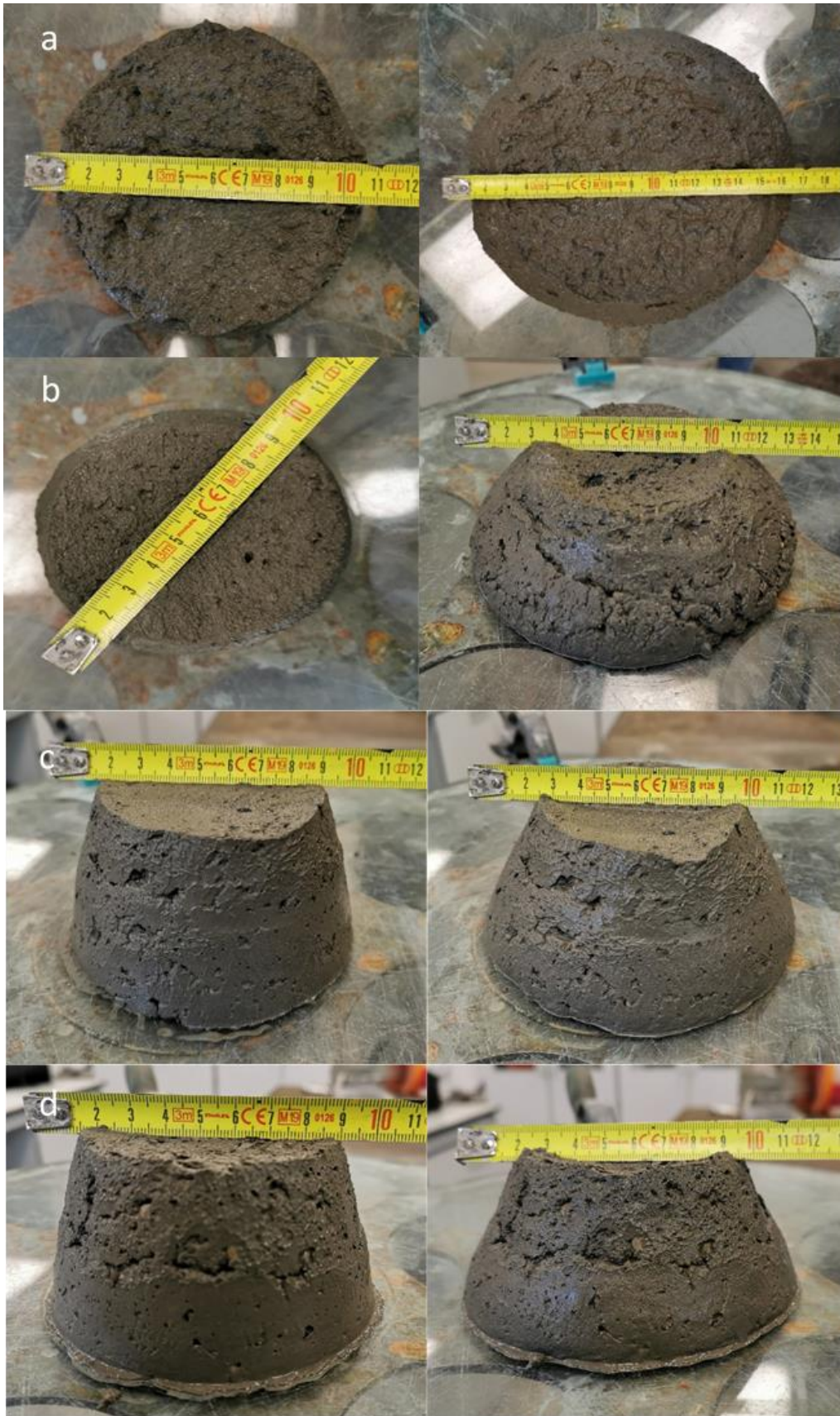
Figura 40. Mediciones del mortero HPC en la mesa de sacudidas antes (izq) y después (der) de los golpes para contenidos de bacteria de a) 0 kg/m 3 b) 7.5 kg/m 3 c) 15 kg/m 3 d) 30 kg/m 3
