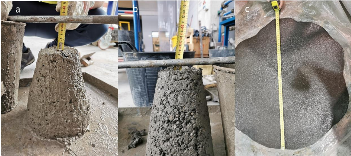
Figura 51. Ensayo de cono de los hormigones a) OPC, b) HPC y c) ensayo de escurrimiento de UHPC
