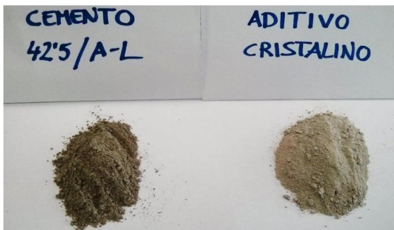
Figura 7. Comparación entre partículas de cemento y adiciones cristalinas (Roig-Flores, 2015)
