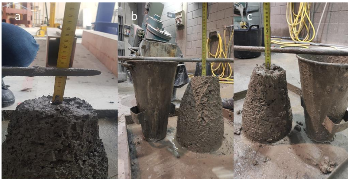
Figura 48. Ensayo de cono de los hormigones HPC a) 0 kg/m 3 , b) 7.5 kg/m 3 , c) 15 kg/m 3
