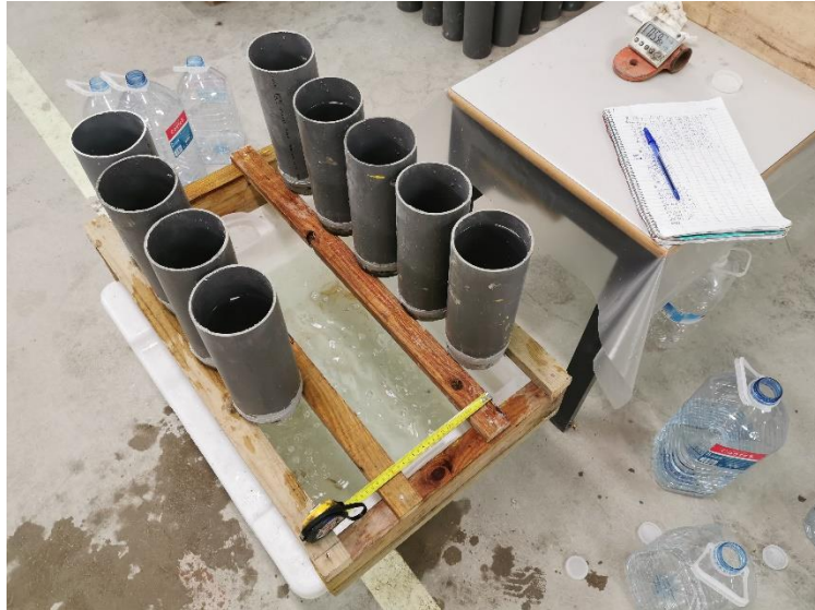
Figura 32. Ensayo de permeabilidad
