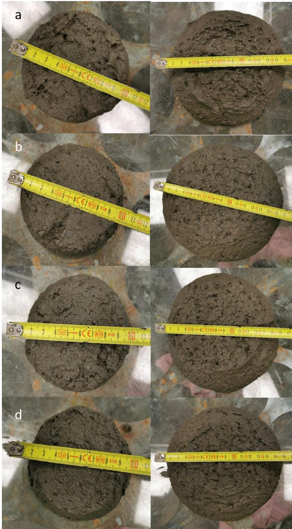
Figura 43. Mediciones del mortero HPC en la mesa de sacudidas antes (izq) y después (der) de los golpes para contenidos de bacteria de a)0% b)10% c)25% d)50%
