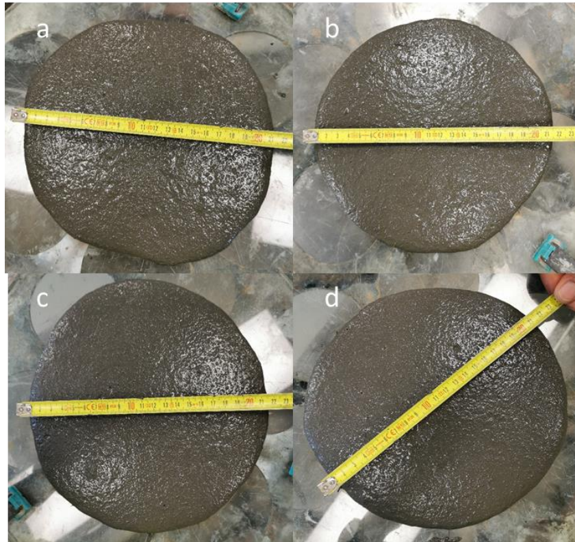
Figura 44. Mediciones del mortero UHPC en la mesa de sacudidas para contenidos de bacteria de a) 0% b) 10% c) 25% d) 50%
