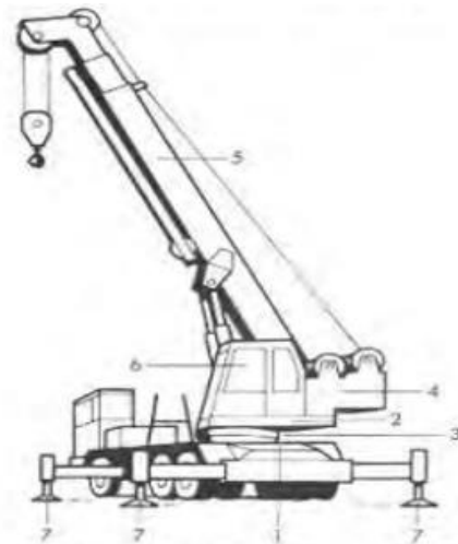
Fig. 1: 1) Chasis portante. 2) Plataforma base. 3) Corona de orientación. 4) Equipo de elevación. 5) Flecha telescópica. 6) Cabina de mando. 7) Estabilizadores
