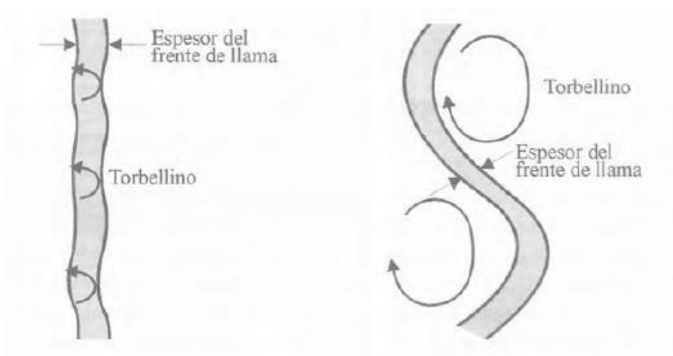
Figura [2.3]. Izquierda: llama distribuida. Derecha: llama distorsionada [2]
