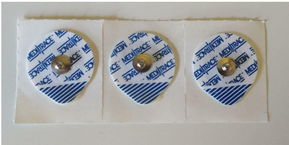
Figura 11 – Electrodos Meditrace (Ag-AgCl) empleados en este proyecto.
