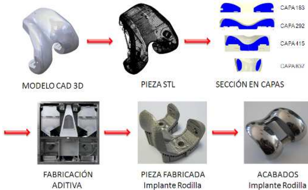
Figura 10. Etapas seguidas durante los procesos de Fabricación Aditiva.
