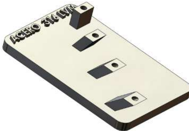
Figura 39. Imagen CAD 3D de la plancha diseñada para el análisis de planos y agujeros inclinados.
