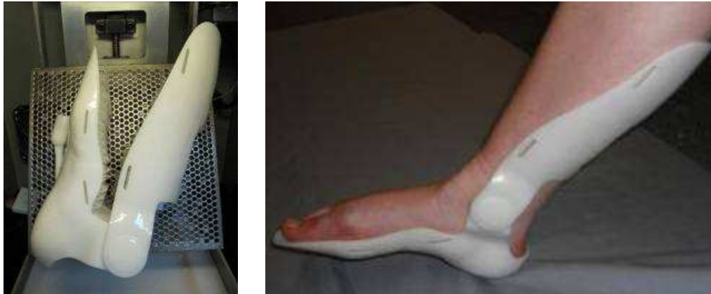
Figura 15. Ortesis tobillo-pie personalizada a la anatomía del paciente, fabricado mediante Estereolitografía. Fuente FABIO proyecto CONSORCIA subvencionado por el Ministerio de Industria, Turismo y Comercio 5 .
