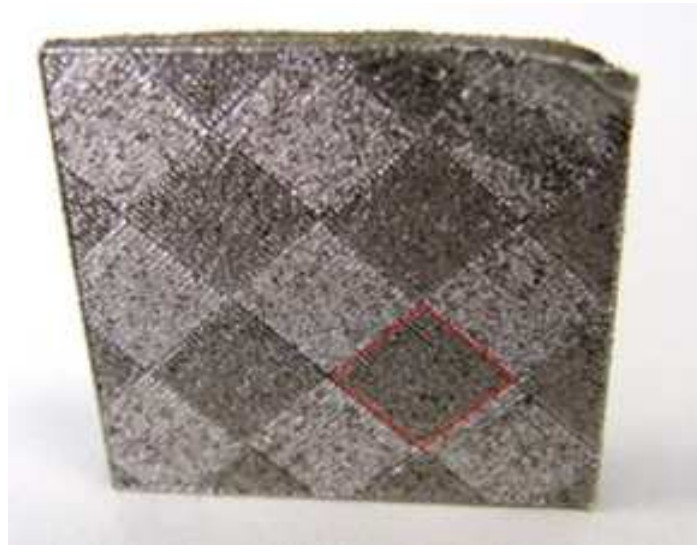
Figura 28. Imagen de una muestra de material fabricada mediante SLM. Detalle de la estrategia de pintado en damero en la última capa y los cordones de soldadura dentro de cada cuadrado. Se aprecian cuadrados (gris claro) donde el laser suelda siguiendo cordones a 45^\circ y cuadrados (oscuros) donde hay cordones a -45^\circ , perpendiculares a los anteriores.
