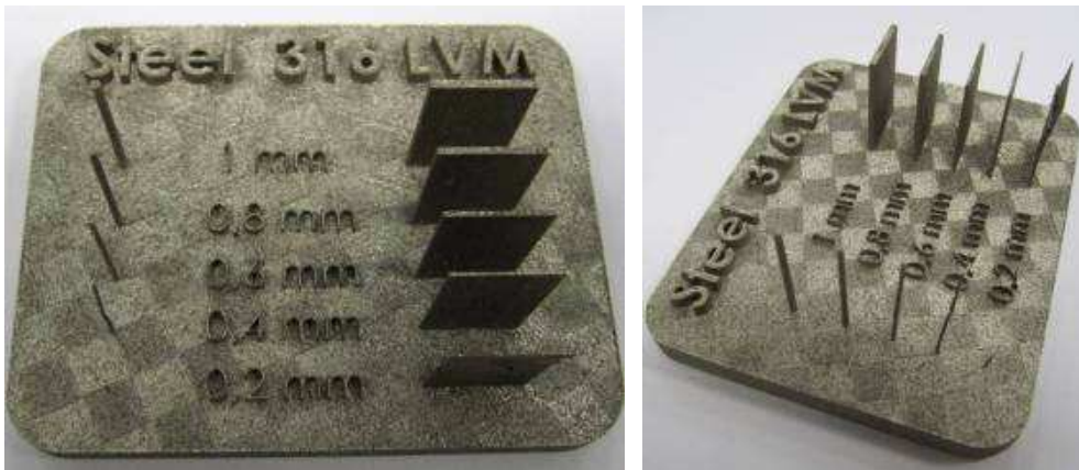
Figura 48. Imágenes de la placa en acero inox. 316 LVM, que muestran las geometrías de detalles mínimos fabricadas por la tecnología SLM.
