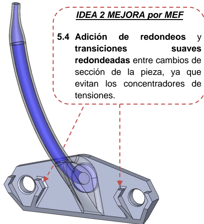
Figura 99. Diseño de detalle del componente. Adición de redondeos para eliminar concentradores de tensiones
