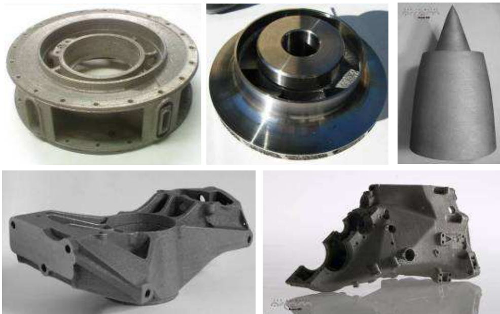
Figura 21. Ejemplos de prototipos fabricados por EBM en Ti6Al4V. Arriba para sector aeronáutico y debajo para automoción. Cortesía ARCAM AB www.arcam.com .
