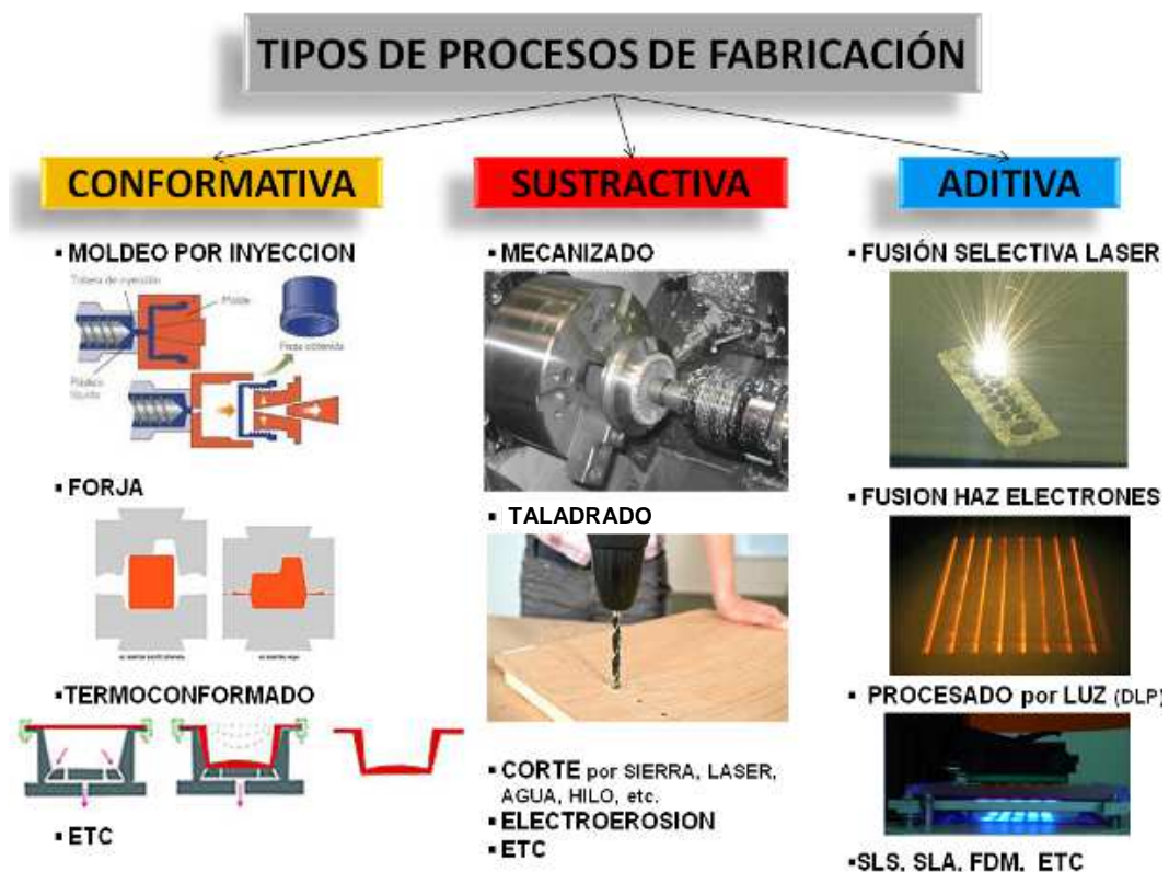
Figura 1. Clasificación de los procesos de fabricación según el modo de procesar el material para obtener la pieza.
