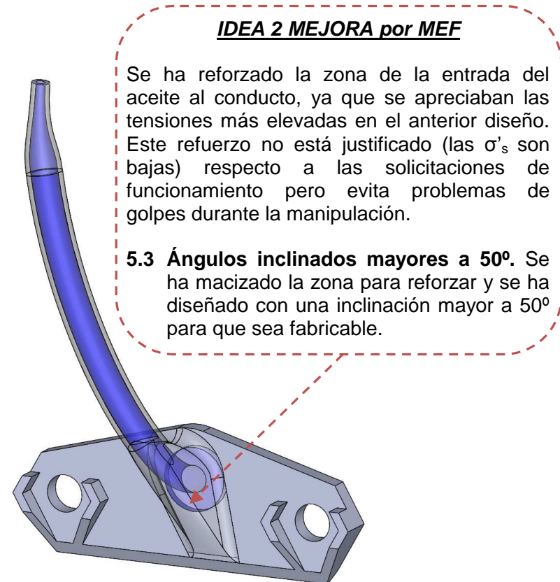
Figura 98. Diseño de detalle del componente. Refuerzo para favorecer fabricación sin soportes.
