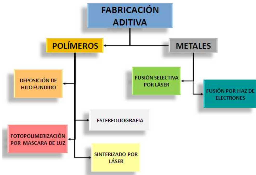
Figura 11. Clasificación de las tecnologías de FA en función del tipo de material que procesan. Se han representado algunas de las tecnologías más representativas.
