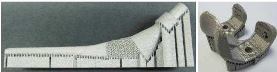
Figura 9. Piezas de titanio fabricadas mediante EBM con los soportes de fabricación.
