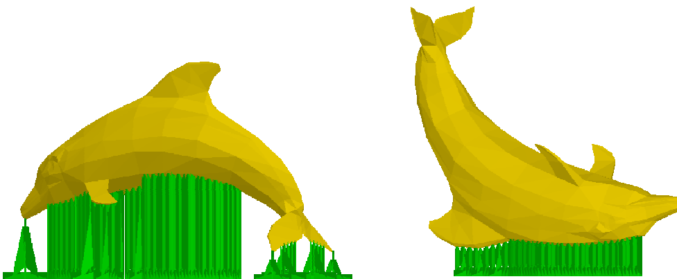
Figura 4. Izquierda, esta orientación del modelo obliga a colocar más soportes que en la orientación de la derecha.
