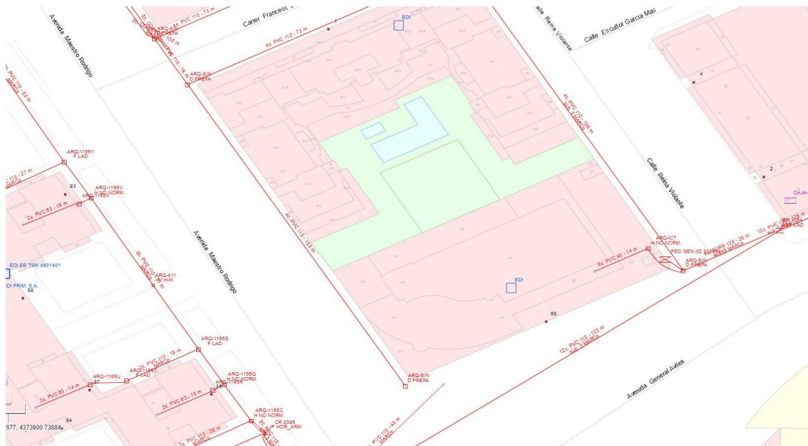
Ilustración 31: Distribución de canalizado exterior existente.
