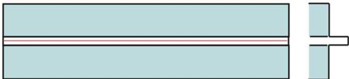
Ilustración 16: Propagación del modo en fibra monomodo.
