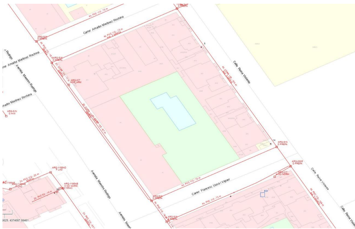
Ilustración 30: Distribución de canalizado exterior existente.
