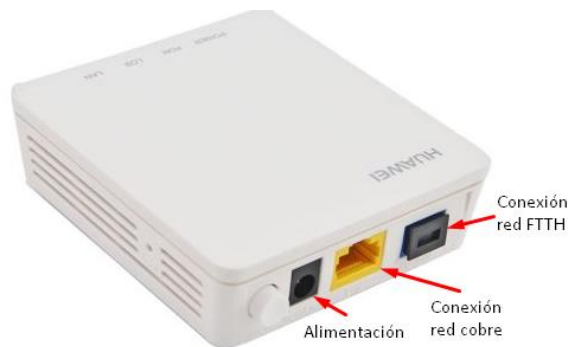
Ilustración 7: ONT de fabricante Huawei.
