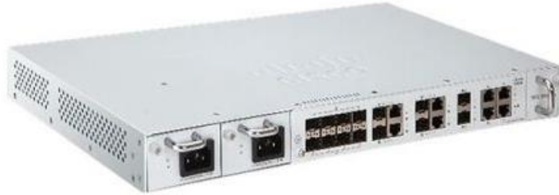
Ilustración 6: OLT de 8 puertos del fabricante Cisco Catalyst.
