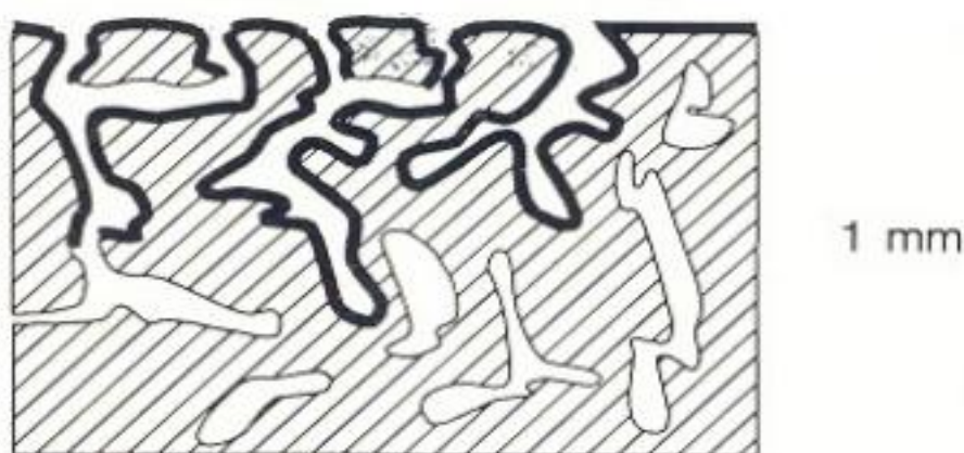
Fig.18 Sezione trasversale di una pietra porosa, trattata con un consolidante di origine organico.
