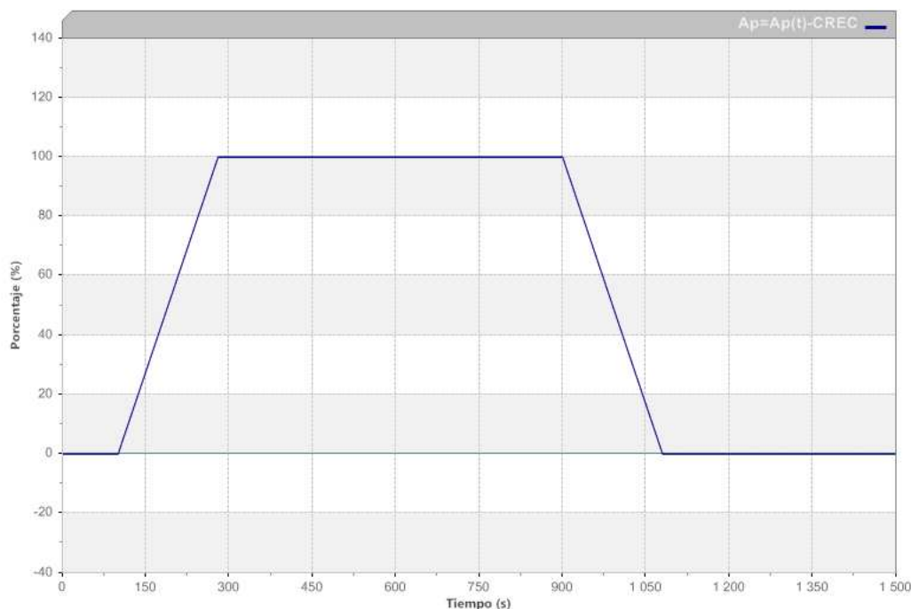
Figura 81. Maniobra analizada en la válvula de corte de DN400
