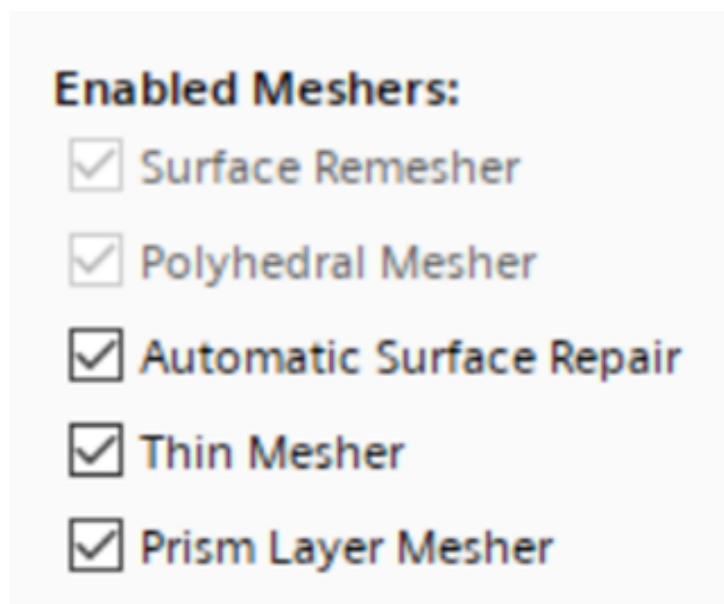
Figura 2.6: Configuración de la malla en STARCCM+
