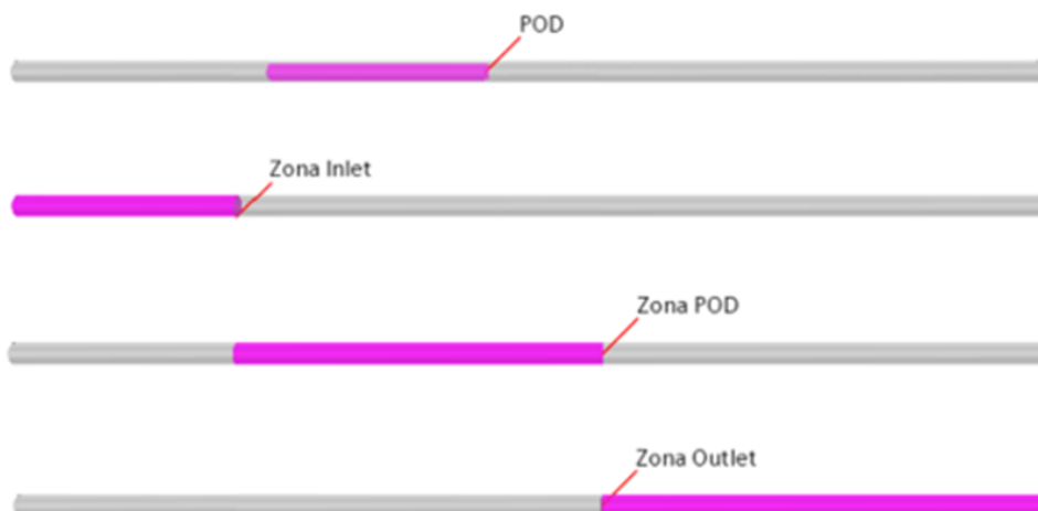
Figura 2.4: Localización del pod y subvolúmenes en los que se divide el tubo
