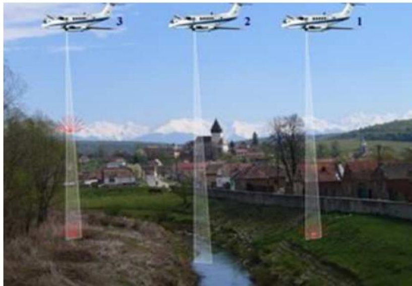
Figura 2. Funcionament del LIDAR amb diferents tipus de superfícies (Dielmo.com, 2011).
