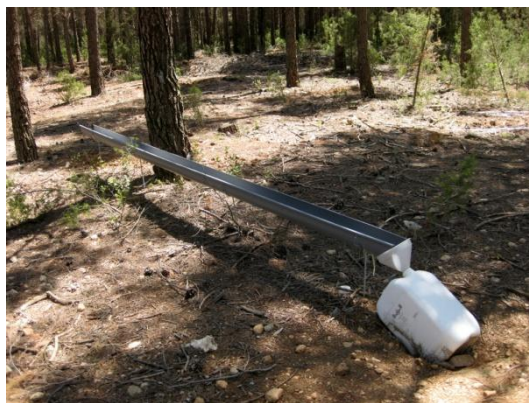
Figura 12. Disposició dels recol·lectors de trascolació (Molina, 2010).
