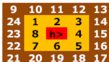
Figura 19. Esquema d'un píxel que és màxim relatiu respecte als seus adjacents (roig). En groc els píxels de la primera fila que es comparen amb el central, i en marró la segona fila de píxels quan s'amplia els píxels amb els que es compara el píxel central. Els números indiquen la numeració correlativa dels píxels (Reyna et al , 2010).
